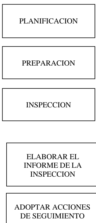
Figura 2.6: Metodología para llevar a cabo con éxito una inspección planeada
