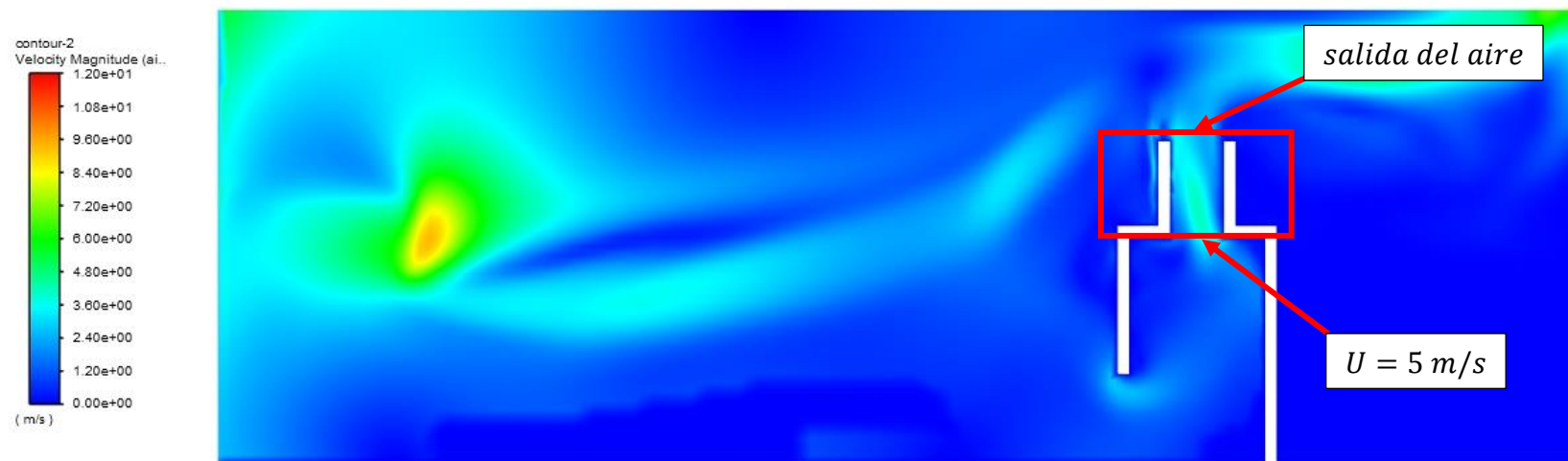
Figura 25: Velocidad de aire en el sistema OWC
