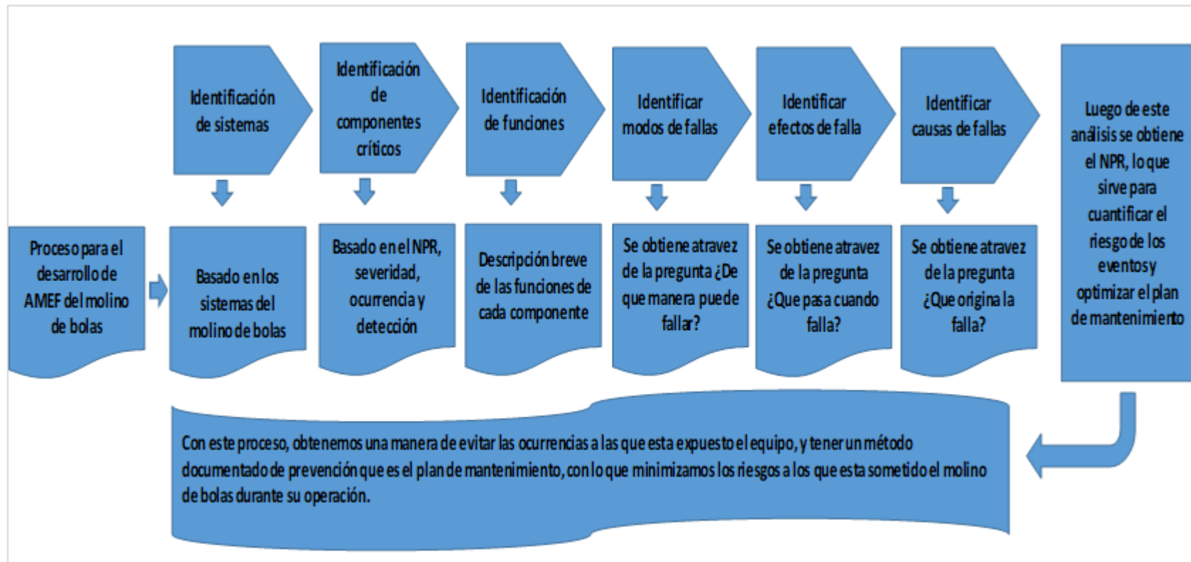
Figura N°54: Flujograma del proceso para obtención del AMEF.
