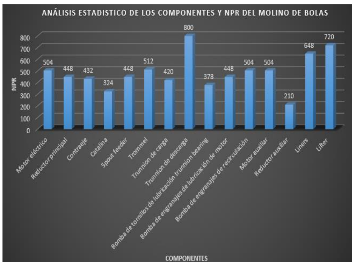
Figura N°70: Estado total de fallas con NPR del molino de bolas outotec 24'x36'.
