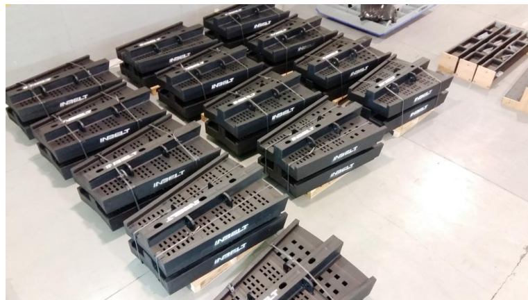
Figura N°77: Composición de revestimientos para el cuerpo de un molino bolas.
