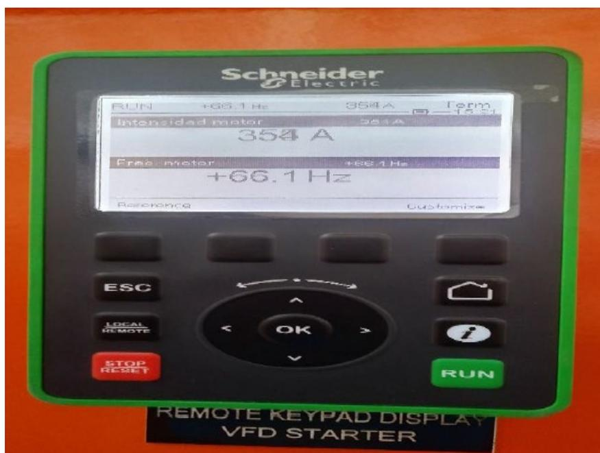
**Figura 6.2:** Display de variador de celda de flotación FC006 en operación
