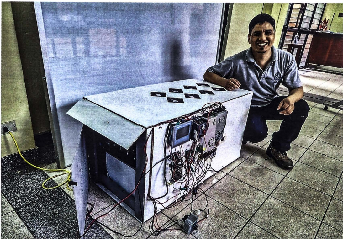
Figura 56. Prototipo furgón climatizado para transporte pollos bebé
