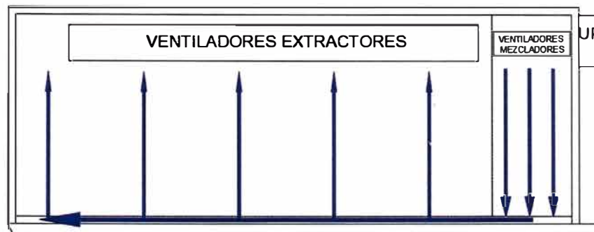
Figura 21. Flujo de aire generado por ventiladores extractores
