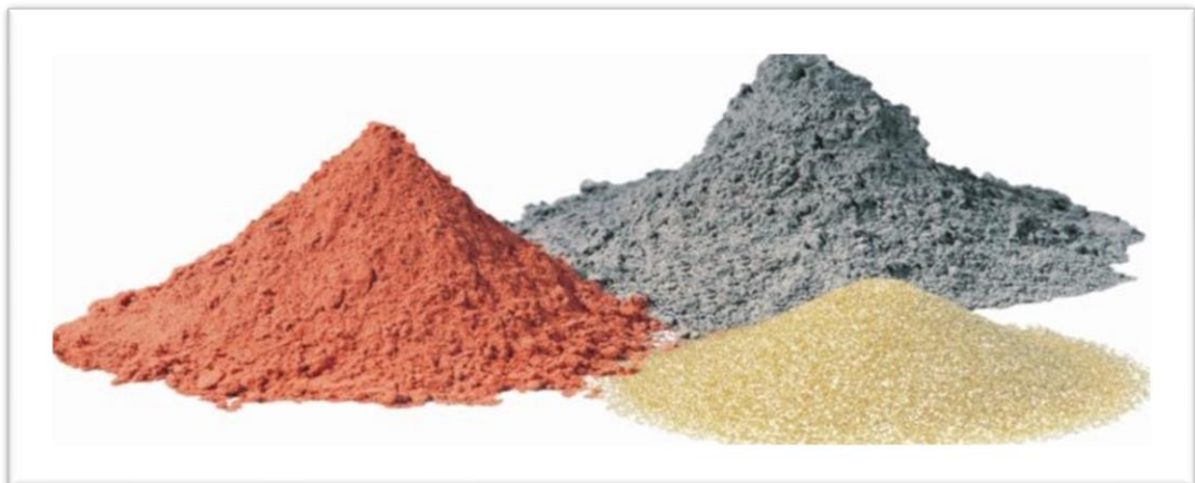
FIGURA N° 14: POLVO METÁLICO (COBRE-ROJIZO, ESTAÑO-PLOMO, BRONCE-DORADO)
