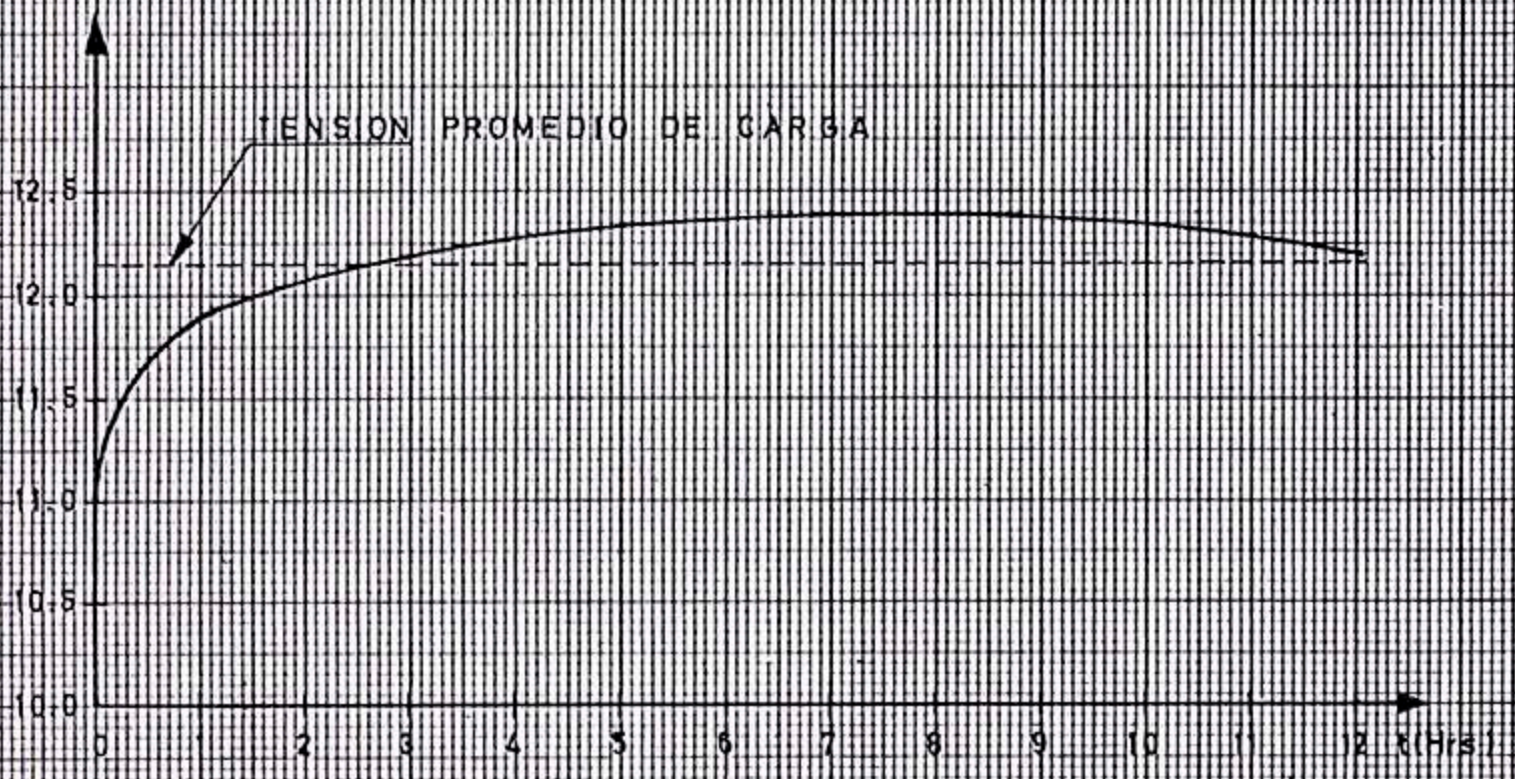
FIG. 31) VARIACION DE LA TENSION DE LA BATERIA DE ACUMULADORES DE ACIDO PLOMO DURANTE EL PROCESO DE CARGA.
