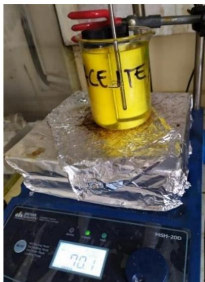
Una vez sintetizados, los polímeros fueron lavados con metanol utilizando un sistema de filtración al vacío. La coloración amarilla del MIP se debe a la presencia de curcumina en la síntesis, en cambio el NIP es blanco pues fue sintetizado sin curcumina. Fueron secados a 70°C por 24h. La formación de cavidades se dará en la siguiente etapa, donde se realiza el lavado empleando un soxhlet para retirar la curcumina del MIP (Figura 32).
