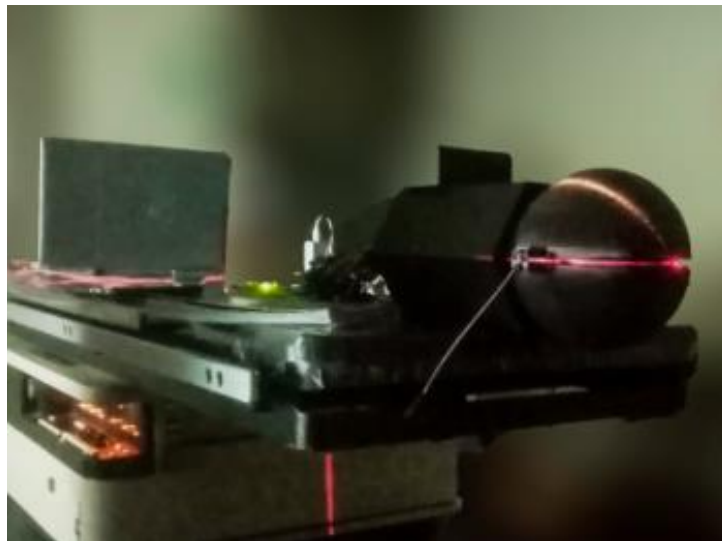
Figura 43: Prototipo de menor resolución con cobertura, en la parte superior detector prototipo con cubierta y sistema de adquisición de datos, en el parte inferior detector conectado a computadora para la lectura.
