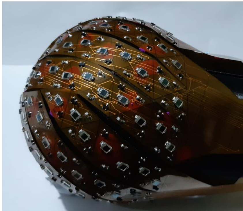
Figura 42: Prototipo de menor resolución sin cobertura, se observan los 135 diodos sobre la estructura formando una superficie esférica
