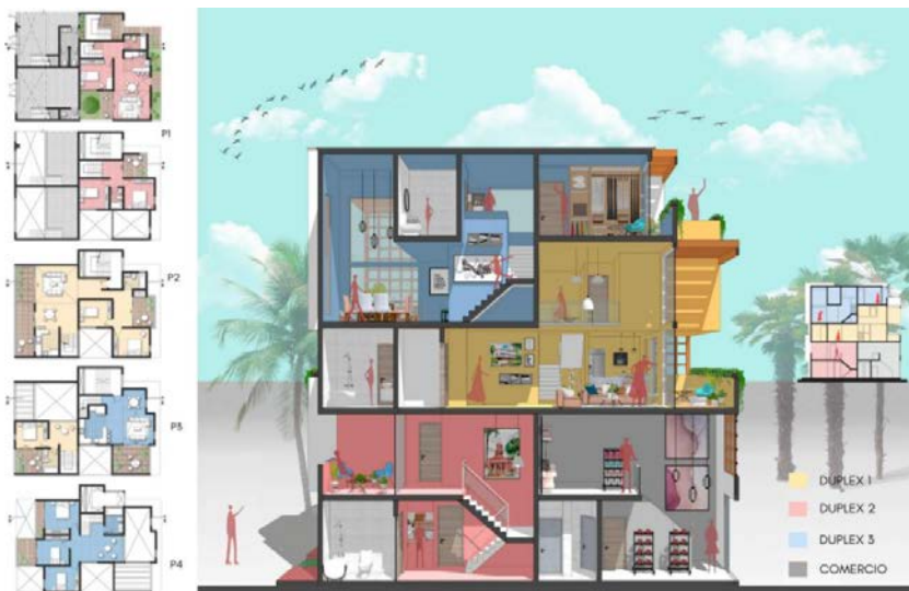
Plantas y corte fugado de la vivienda
