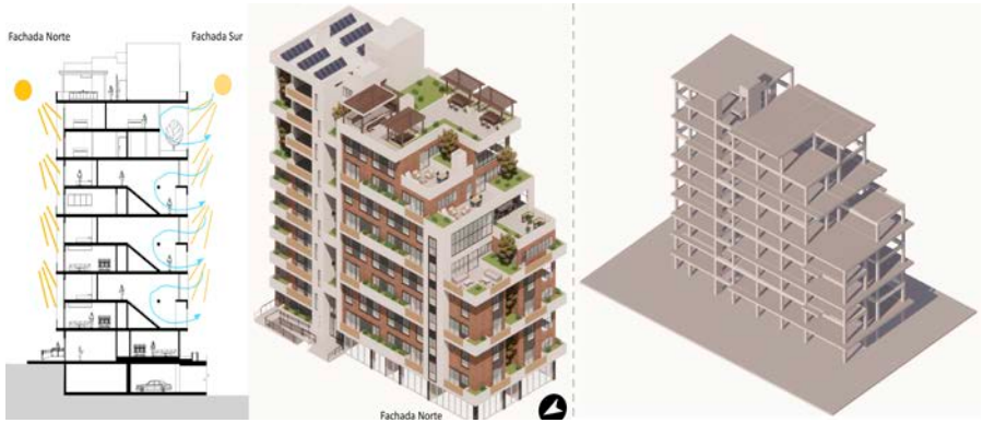
Estrategias bioclimáticas, volumetría y esquema estructural.
