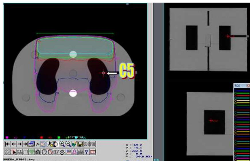
FIG. 4.34. Fantoma de tórax campo 20X20 cm<sup>2</sup> corrección densidad CALIBRADO punto de cálculo C5.
