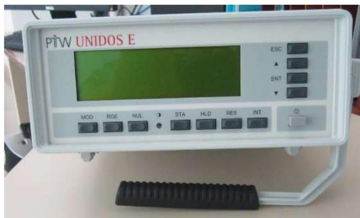
FIG. 3.4. Electrómetro PTW Unidos E.
