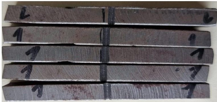
Figura 27 Probetas de la junta soldada para ensayo Charpy
