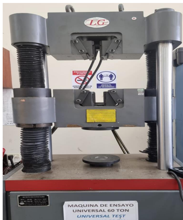
Figura 22 Máquina de ensayo de Tracción marca LG
