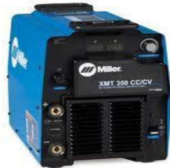
Figura 11 Maquina Soldadora portátil Miller XMT359CC/CV
