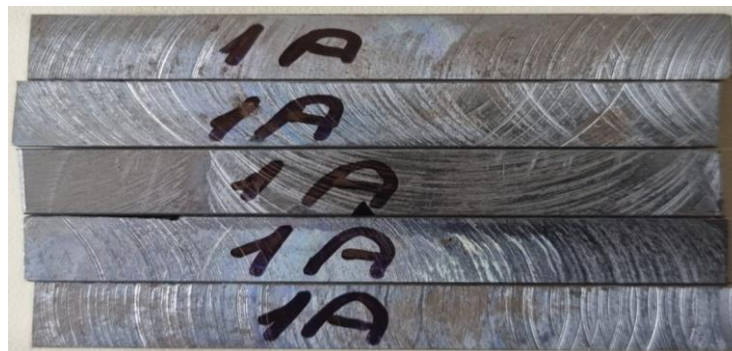
Figura 28 Probetas de cordón de soldadura para ensayo Charpy
