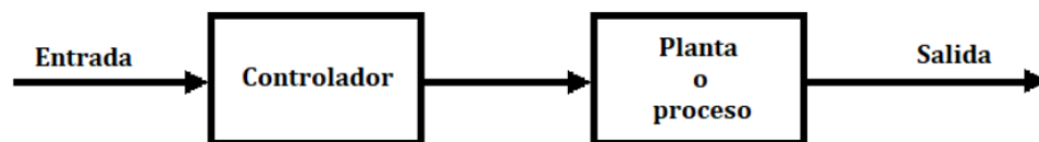
Figura 23 Sistema de control en lazo abierto.
