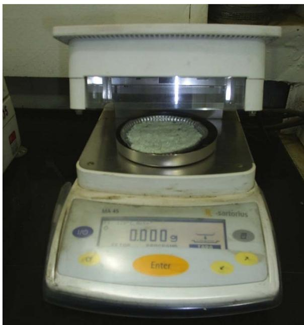
Figura 15. Balanza Sartorius MA45 para la determinación de materia volátil a 120°C del xantato.
