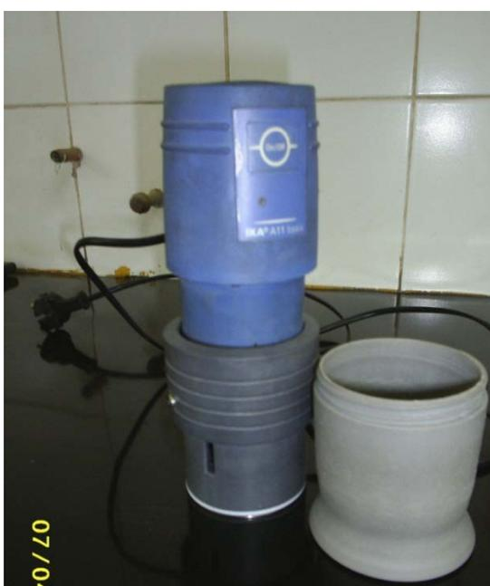
Figura 16. Molino analítico para pulverizar las muestras de xantato (capacidad máxima 50 gramos)
