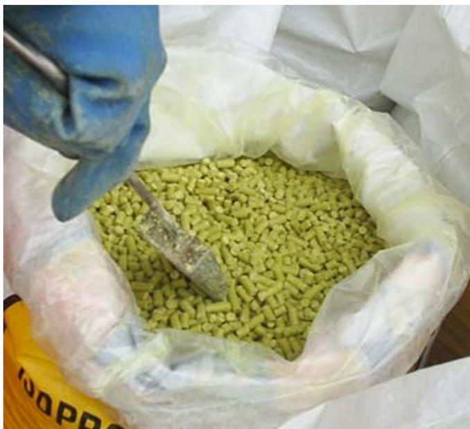
Figura 11. En la fotografía se observa al xantato isopropílico de sodio peletizado que produce Reactivos Nacionales S.A. Actualmente ésta es la presentación del xantato que se comercializa principalmente.
