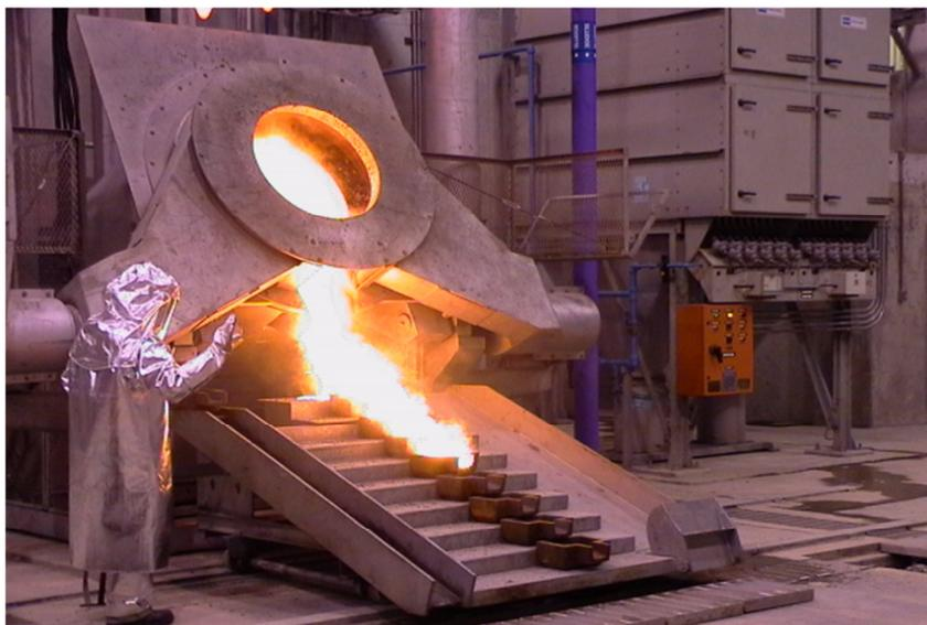
*Figura 11.* Fundición de barras doré. Minera Yanacocha.
