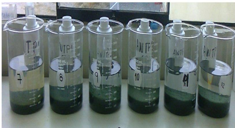
*Figura 45.* Precipitación de metales en agua ácida a diferentes pH.
