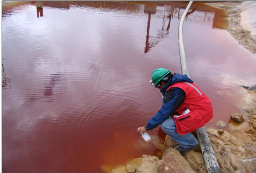
*Figura 17.* Retención de agua ácida. Tajo Yanacocha Norte MYSRL.
