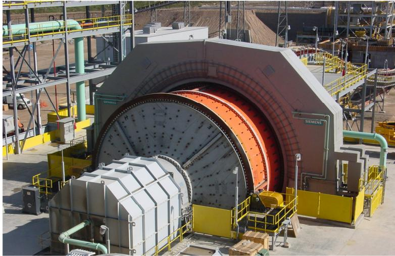
**Figura 9.** Molino SAG (Semi autógeno).
