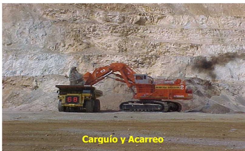
*Figura 3.* Carguío y acarreo de mineral, Minera Yanacocha.
