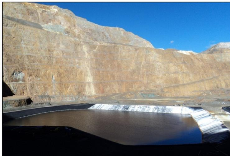
*Figura 28.* Retención de agua ácida. Tajo Yanacocha Norte, MYSRL.
