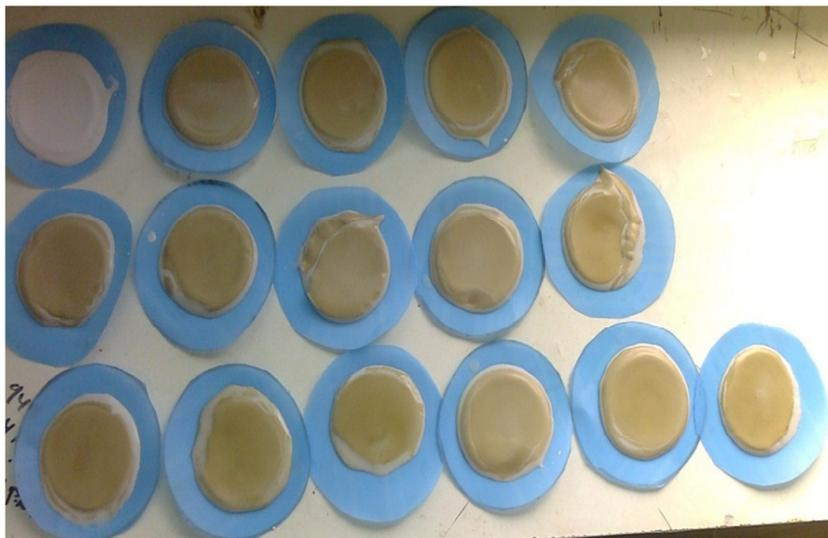
*Figura 42.* Precipitación de sulfuros metálicos en los filtros clarificadores.
