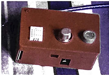
Figura 50. Sensor electrónico para medir CO, humedad y temperatura.
