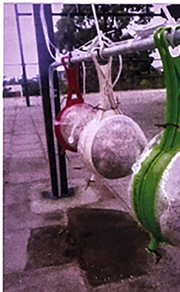
Figura 55. Dispositivos húmedos para gotas cada 7 segundos.
