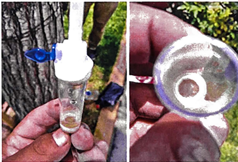
Figura 40. Obstaculización en el filtro.
