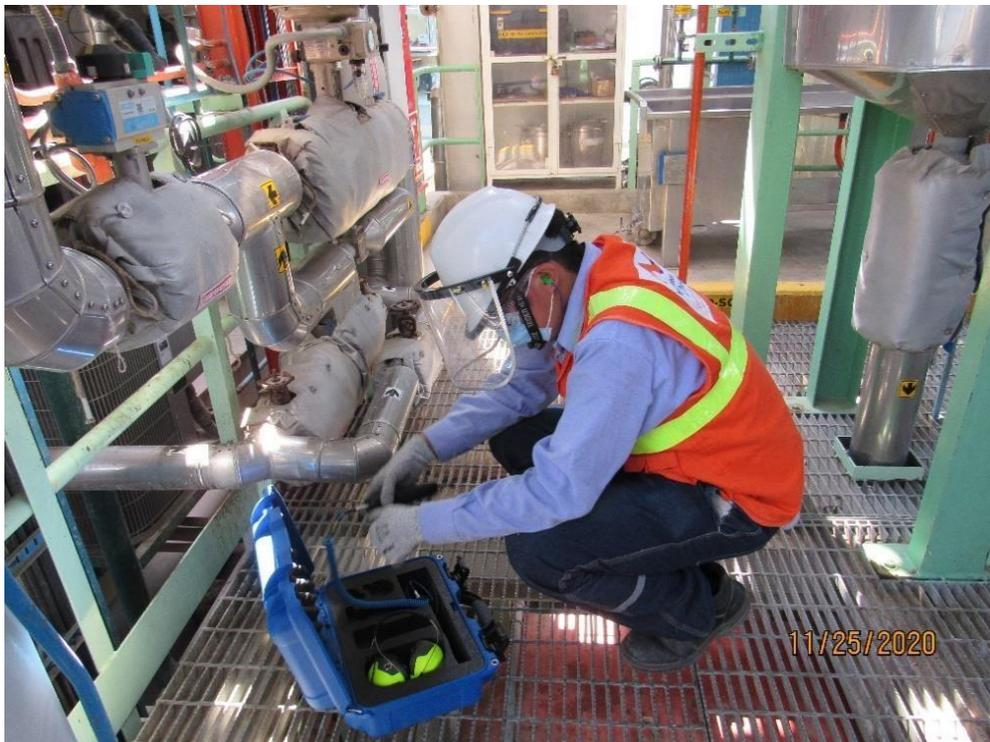
**En la figura N°09 se muestra el dispositivo de medición por ultrasonidos que será utilizado en las trampas de vapor presentes en las tuberías.**
