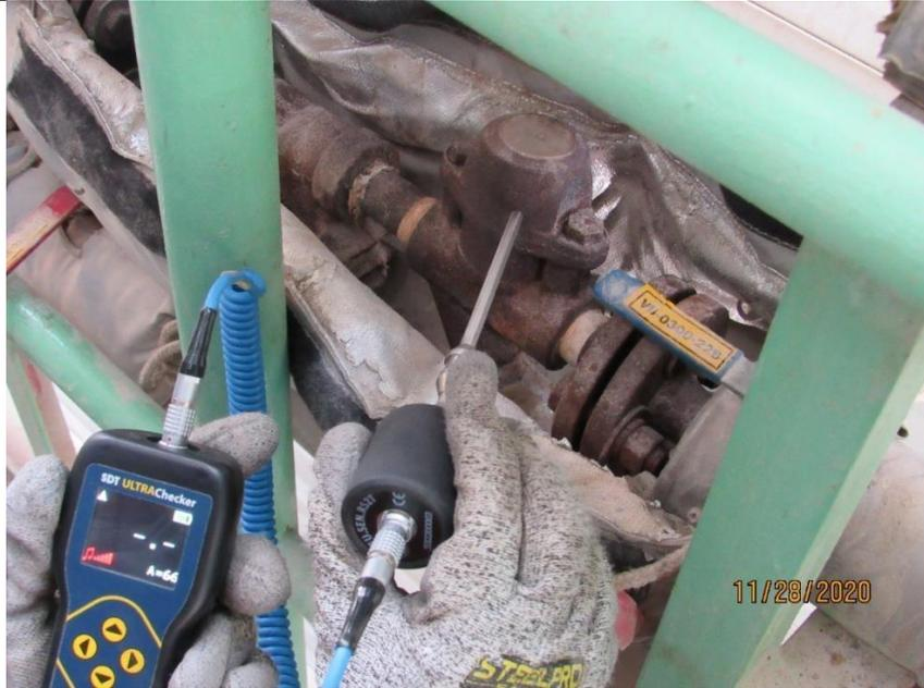
**En las fotografía N°55 se muestra la revisión de las trampas de vapor mediante el dispositivo de medición por ultrasonido.**
