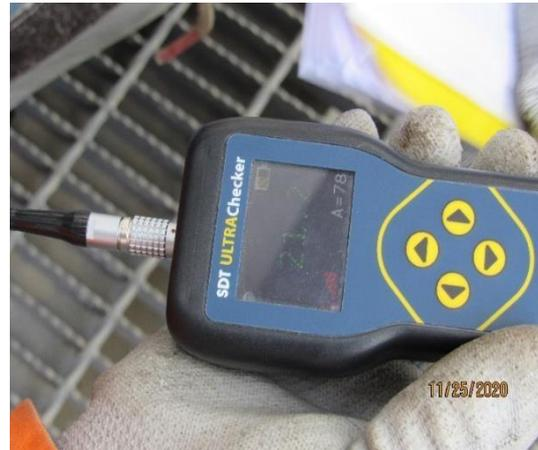
En las figuras N°03 y N°04 se muestra el uso del detector de ultrasonidos para verificar el estado de las trampas de vapor.
