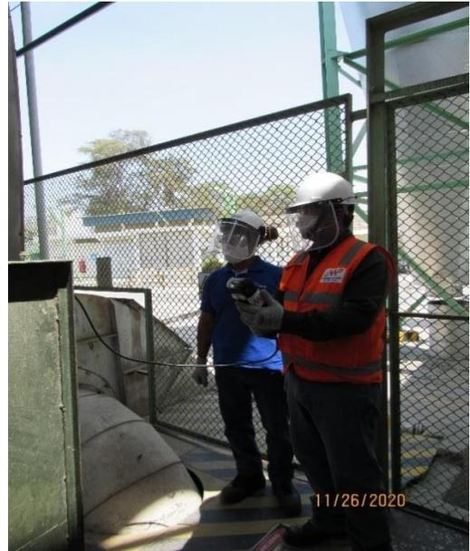
**En las fotografías N°19 y N°20 se muestra el uso del sensor de gas para el análisis de gases de combustión de la caldera Buckauwolf.**
