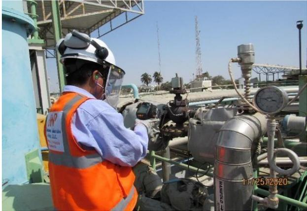
**En la fotografía N°07 se muestra la medición de temperatura de la entrada de vapor a Hidrólisis mediante el uso de la cámara termográfica.**
