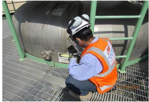
**En la fotografía N°08 se muestra el uso de la cámara termográfica en el sensor de temperatura del tanque Tarpón.**
