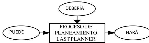
Figura N°2.4 Proceso de determinación de asignaciones con el LPS.
