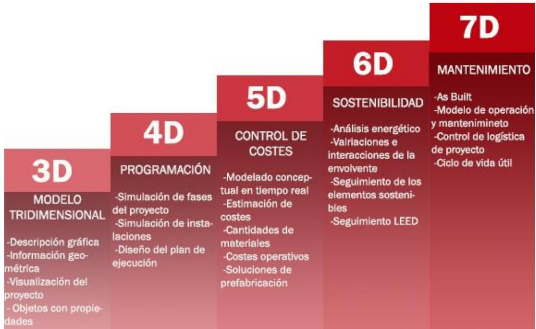
Figura N°2.12 Dimensiones de BIM.
