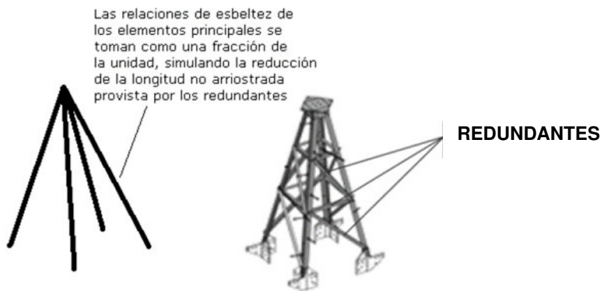
Figura N° 17 Ubicación típica de elementos redundantes
