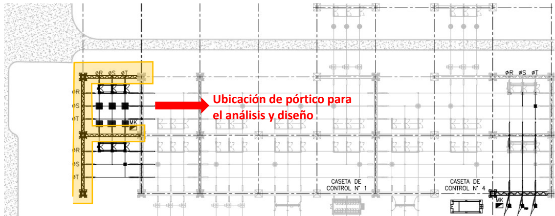
Figura N° 38 Ubicación de pórtico para el análisis y diseño
