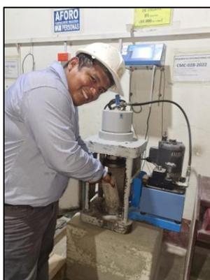
**Figura 33** Ensayo a compresión del concreto.
