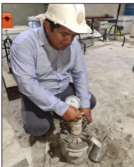
**Figura 24** Contenido de aire del concreto.
