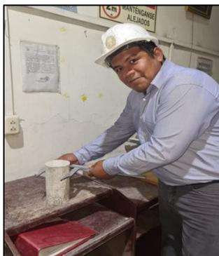
**Figura 32** Medición de diámetros de las probetas.
