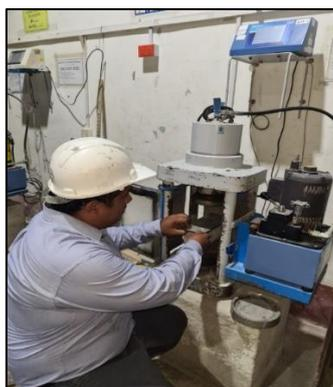
**Figura 42** Ensayo a tracción del concreto.
