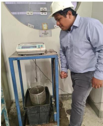
**Figura 11** Peso de la piedra superficialmente seca sumergida en agua.
