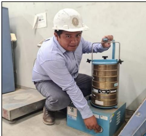
**Figura 4** Tamices para ensayo granulométrico de la arena.
