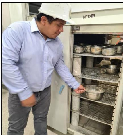
**Figura 13** Contenido de humedad de la arena.
