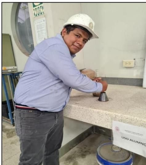
**Figura 10** Picnómetro y cono para ensayo de peso específico y absorción.
