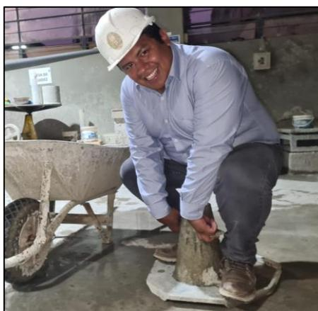
**Figura 18** Equipo para ensayo de asentamiento del concreto.
