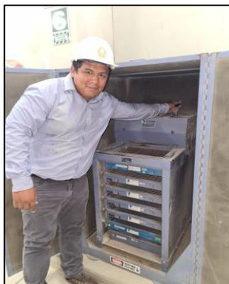
**Figura 7** Tamices para ensayo granulométrico de la piedra.
