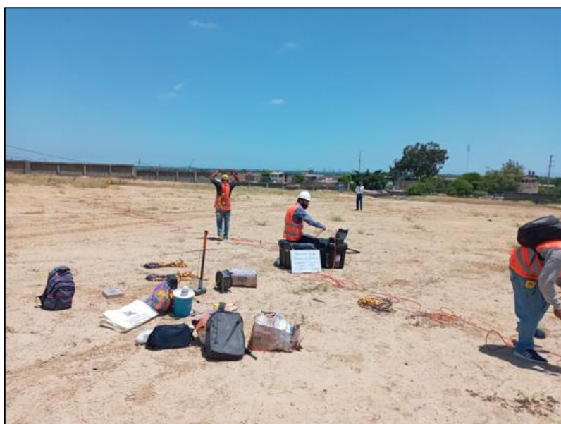
Figura 17 Muestra el tendido de la línea sísmica LS-08.
