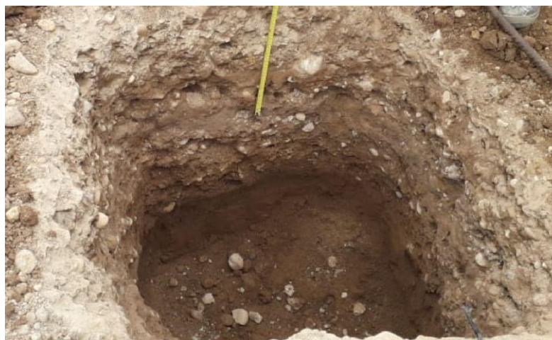
Figura N° 4.9: Exploración manual Calicata de 1.52m de profundidad
