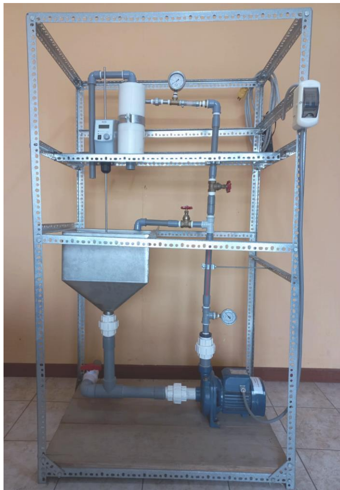
Figura 10. Sistema real del circuito cerrado de concentración en WOC.
