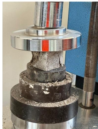
Figura 12. Ensayo de resistencia a la compresión en morteros
