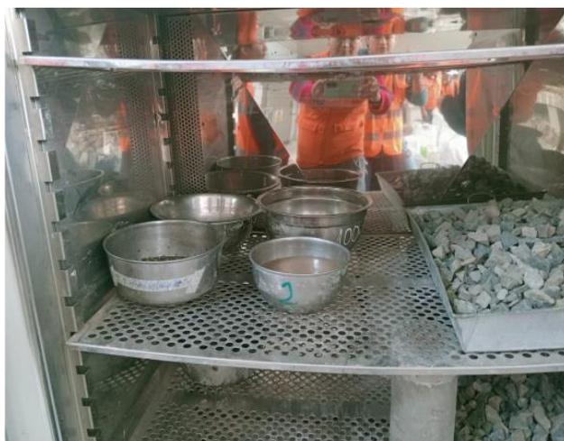
**Figura 3.** Muestra en el horno después de 24 horas
