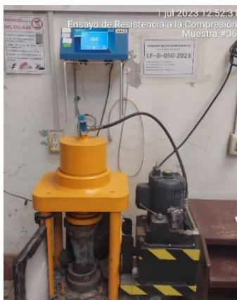
Figura 1. Ensayo de resistencia a la compresión.
