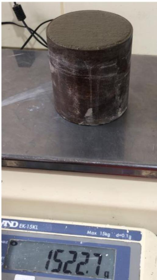
Figura 11. Peso del mortero contenido en el recipiente.
