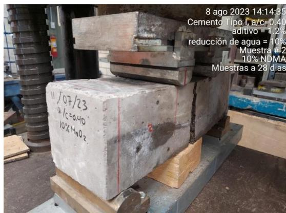
Figura 3. Ensayo de resistencia a la flexión en los tercios.
