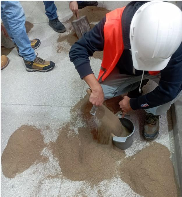
Figura 4. Determinación del peso unitario suelto de la arena.
