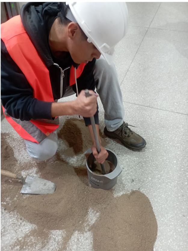
Figura 5. Determinación del peso unitario compactado de la arena
