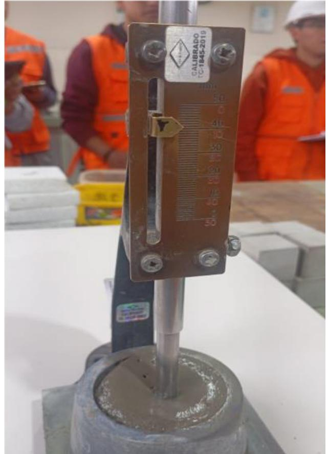
Figura 8. Prueba de consistencia
