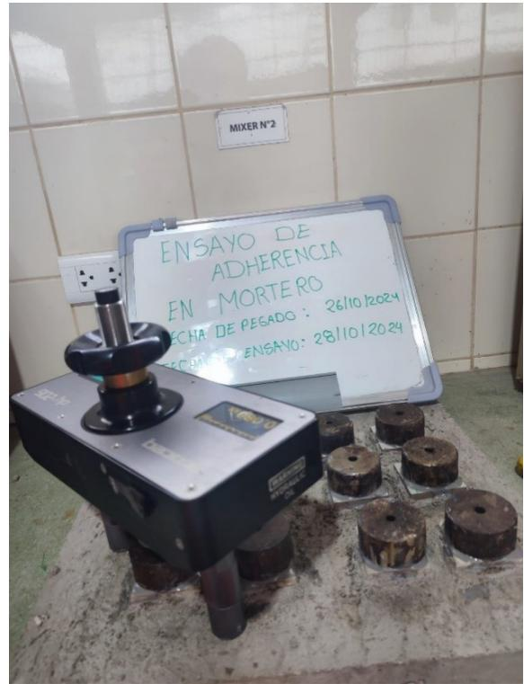
Figura 12. Adherencia del mortero (Pullover)
