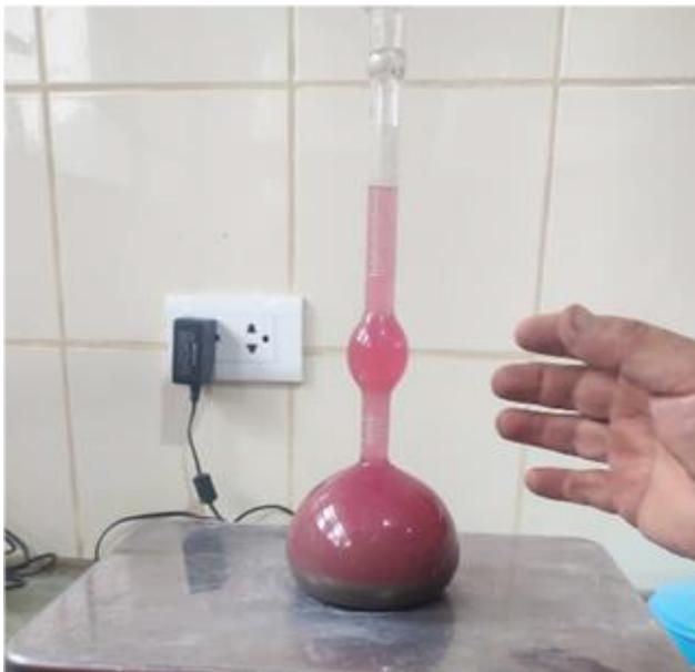
Figura 9. Densidad del cemento usando frasco Le chatellier
