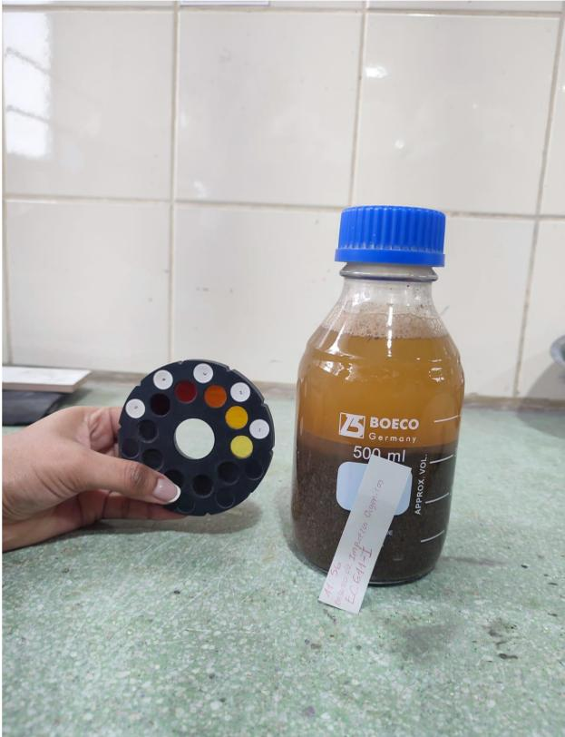
Figura 7. Prueba colorimétrica de Impurezas orgánicas en la arena usando el patrón de Gardner.
