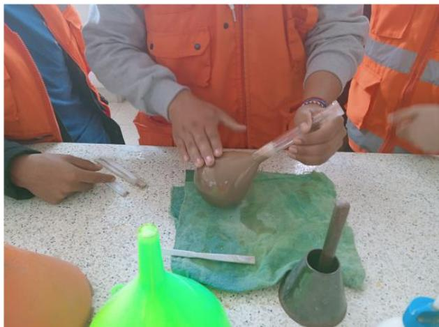
**Figura 2.** Movimiento circular de la fiola para la eliminación de las burbujas de aire atrapadas
