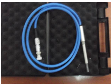
Figura 9. Cámara de ionización PTW FREIBURG TN 30013. Foto tomada por el autor por cortesía de IEEN.
