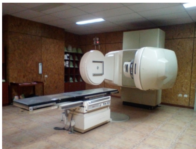
Figura 8. Acelerador Lineal Varian Clinac 6/100. Foto tomada por el autor por cortesía de IEEN.
