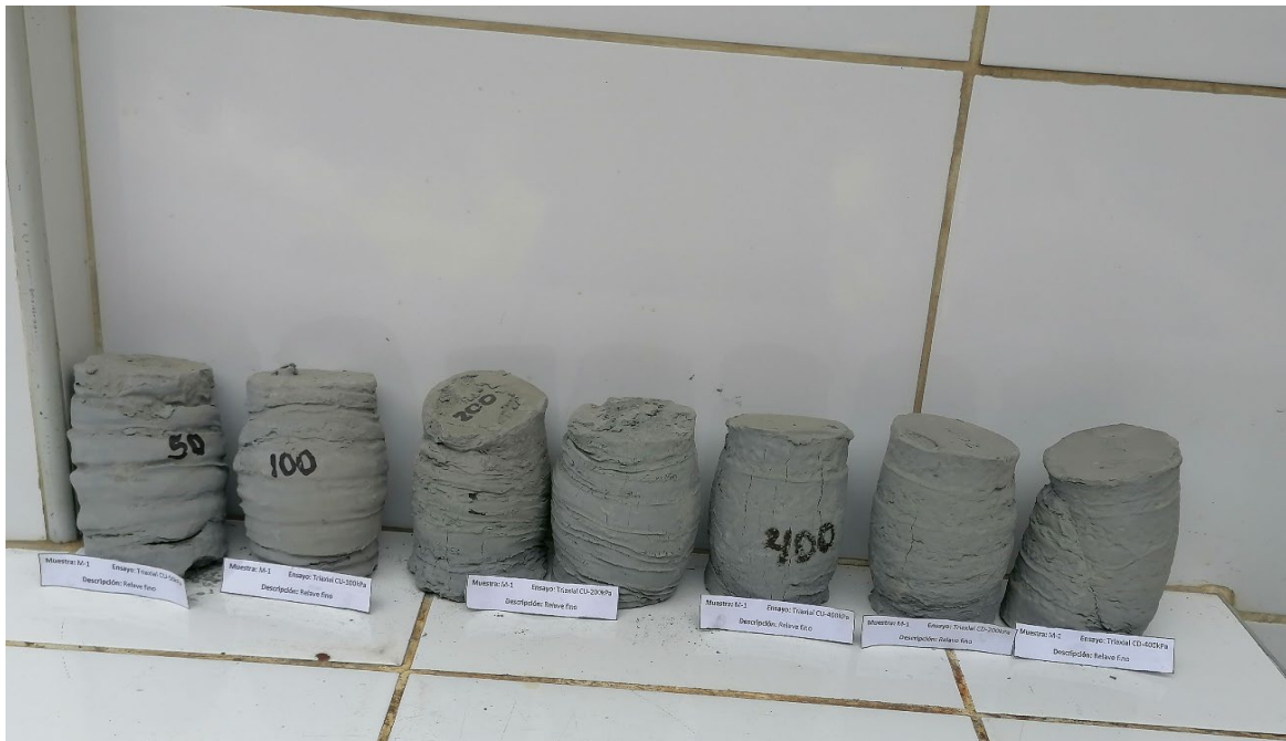
Especímenes ensayados en condiciones drenados y no drenados de la muestra de relave fino M-1
