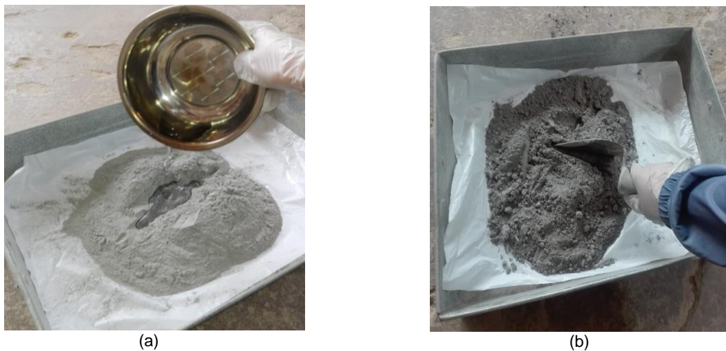
Figura 3.12 Preparación de la muestra. (a) Mezcla de la muestra de relave con agua. (b) Mezcla uniforme de la muestra de relave.
