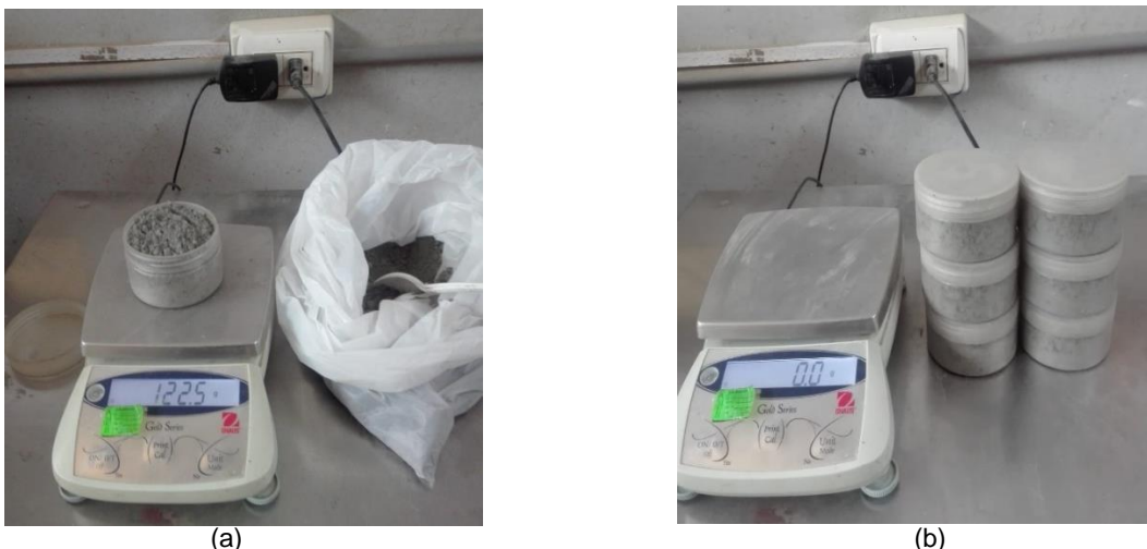
Figura 3.13 Peso de las muestras de relave. (a) Peso de cada porción. (b) Seis porciones de la mezcla de relave.
