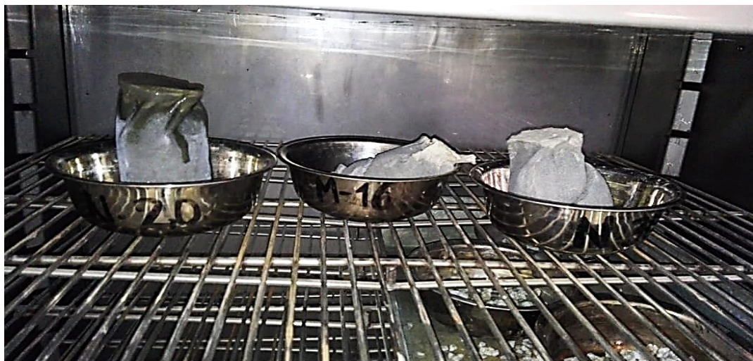
Figura 3.24 Secado de los especímenes de la muestra M-3 en el horno para determinar el contenido de agua.
