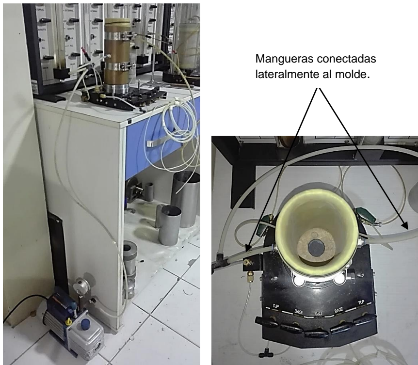
Figura 3.16 Instalación de la bomba de vacío al molde de reconstitución.
