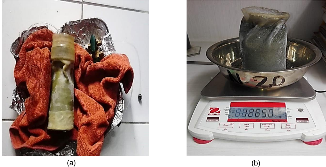
Figura 3.23 Peso del espécimen de relave congelado. (a) Secado del espécimen con una franela (muestra M-3) (b) Peso del espécimen congelado (muestra M-3).
