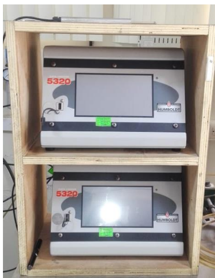
Figura 3.7 Fotografía del adquisidor de datos.
