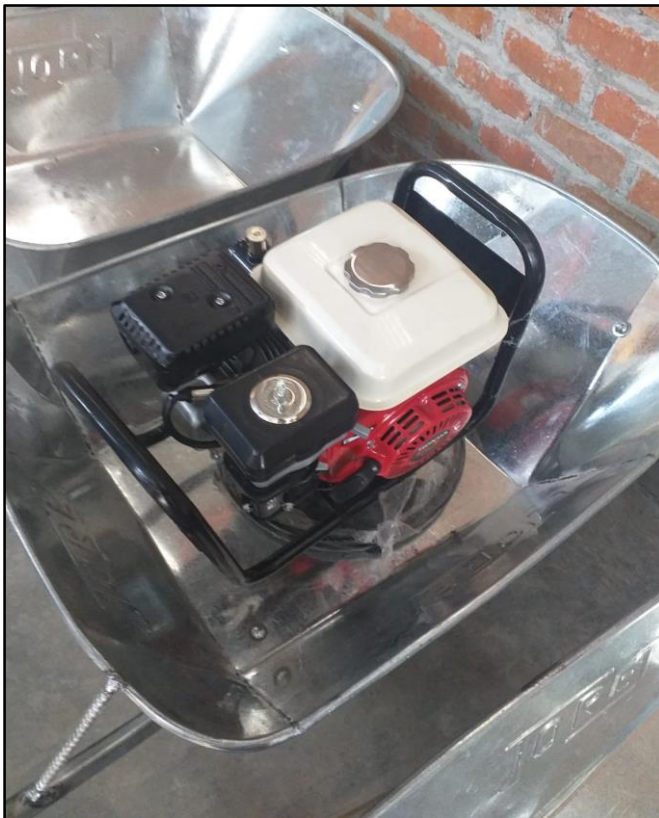
DISPONIBILIDAD DE UN GENERADOR NUEVO PARA ABASTECER DE ENERGÍA PARA EL EQUIPO DE CORTE DEL FIERRO.
