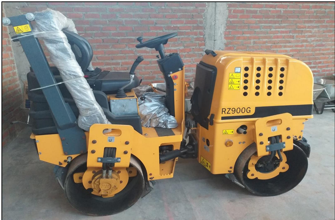
TAMBIÉN SE HA TENIDO LA DISPONIBILIDAD DE UN RODILLO PARA LA COMPACTACIÓN DE RELLENOS.
