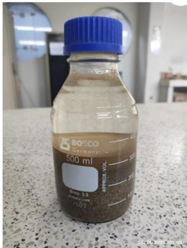
Figura II.8: Impurezas orgánicas en el agregado fino utilizado.
