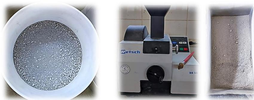
Figura II.3: Proceso en bucle de trituración del RCP.
