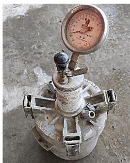
Figura III.11: Determinación del contenido de aire en mezclas de concreto.
