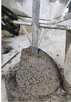
Figura III.9: Determinación del Slump en mezclas de concreto.
