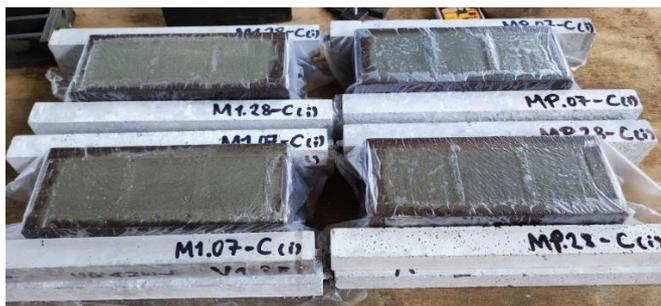
Figura III.7: Cubos de mortero patrón (100% PC) y mortero de análisis (80% PC + 20% RCP).
