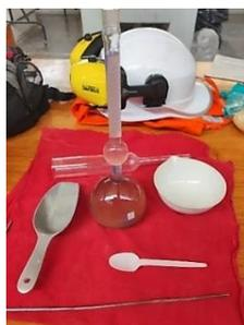
Figura III.4: Ensayo de Densidad del RCP.
