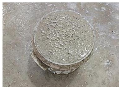
Figura III.10: Determinación del peso unitario en mezclas de concreto.
