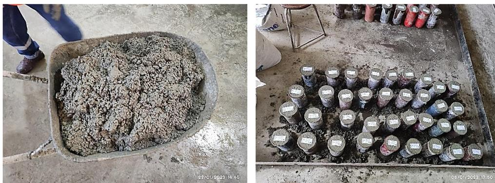
Figura III.8: Muestreo de mezclas de concreto.
