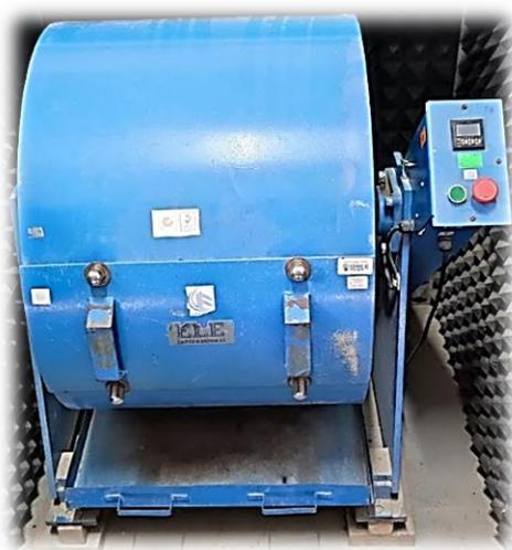
Figura II.2: Máquina de "Los Ángeles", empleada para la pulverización del RCP.
