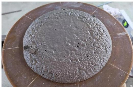
Figura III.5: Ensayo de fluidez en morteros.
