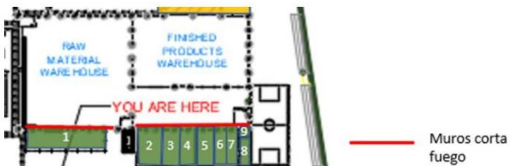
Esta protección descrita es la adecuada siempre y cuando, se realice la evaluación estructural de los muros y cambio de los techos, para la instalación de los rociadores. En caso no se realice dichas modificaciones, se debe disponer con un caudal de mangueras de aproximadamente 700 gpm, para evitar la propagación del fuego al resto de los ambientes, ya que en caso contrario se podría originar la pérdida total de la nave.
