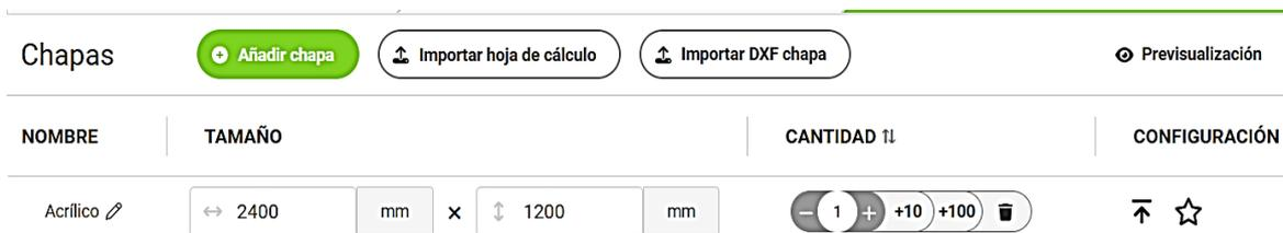
*Nota:* Configuración del largo y ancho del acrílico en el software de anidamiento. Fuente propia
