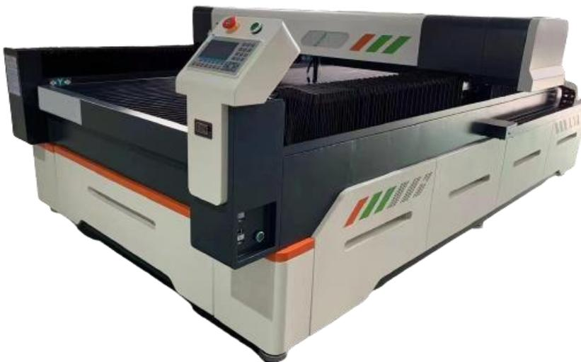
*Nota:* La imagen representa un láser de CO<sub>2</sub>. Tomado de fabricación de maquinaria de Jinan Jinshengxing (2012) "Maquinado de grabado láser CO<sub>2</sub> 1525"
