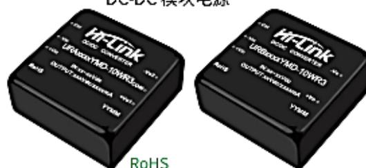
UR(A)B\_YMD-10WR3 系列产品输出功率为 10W, 4:1 宽电压输入范围, 效率高达 91%, 1500VDC 的常规隔离电压, 允许工作温度 -40°C to +85°C, 具有输入欠压保护, 输出过压、过流、短路保护功能, 裸机满足 CISPR32/EN55032 CLASSA, 广泛应用于医疗、工控、电力、仪器仪表、通信、铁路等领域。
