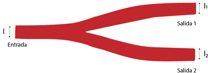
Figura 4.4 diseño de un divisor de potencia Y-branch
