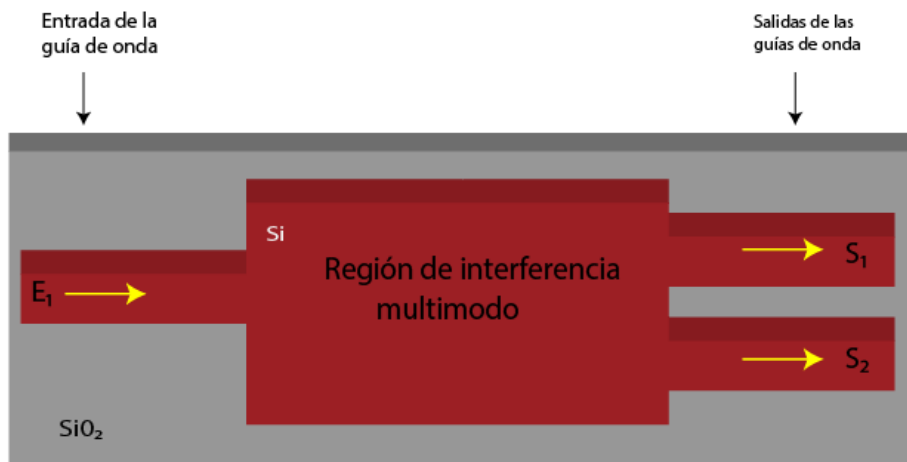
Figura 3.12 diseño de un interferómetro multimodo continuo CWG de 01 entrada y 02 salidas.
