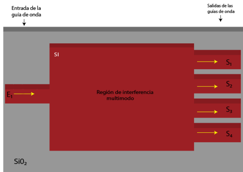
Figura 3.13 diseño de un interferómetro multimodo continuo CWG de 01 entrada y 04 salidas.
