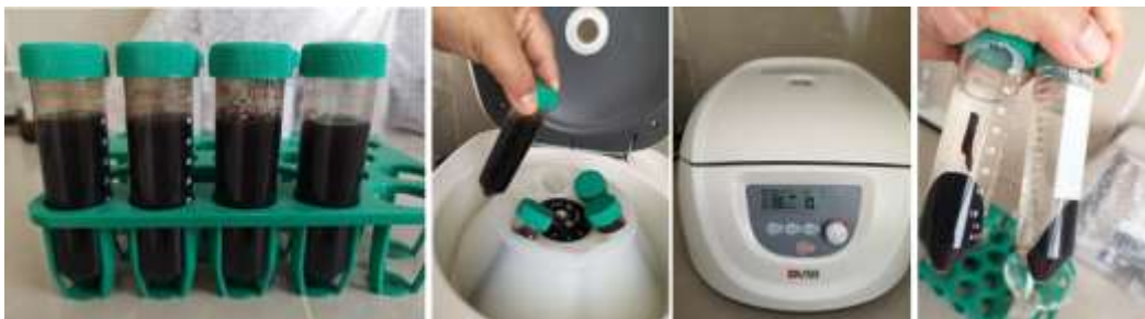
Figura 3. 11 Para la separación de los precipitados de la fase líquida se sometieron a centrifugación por 10 min y 3500RPM.
