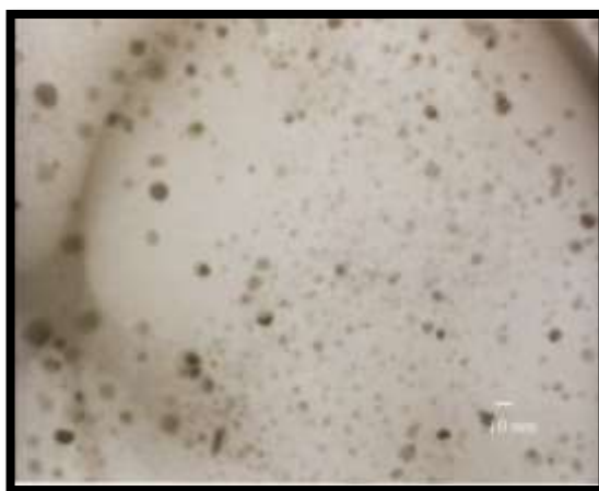
Figura 2. 14 Micrografía TEM de una muestra de magnetita obtenida por el método de coprecipitación
