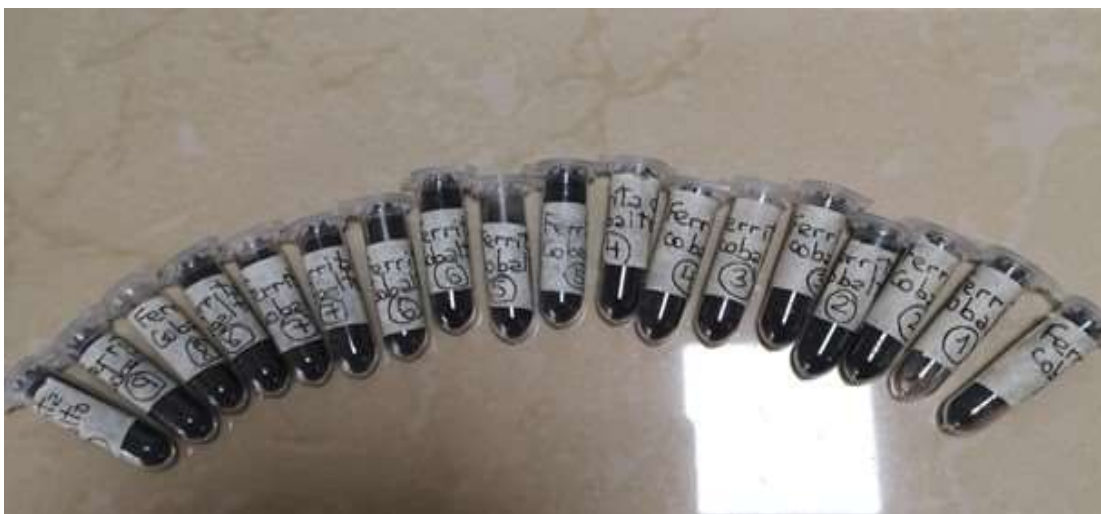
Figura 3. 15 Muestras de ferritas de cobalto sintetizadas por coprecipitación
