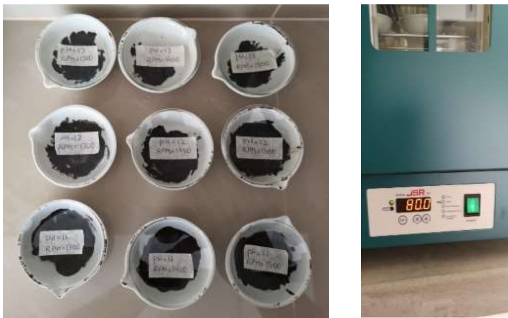
Figura 3. 12 Los precipitados fueron colocados en cápsulas de porcelana y luego en una estufa para su secado a 80°C por 8 horas.
