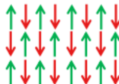
Figura 2. 6 Alineación de los momentos dipolares magnéticos en materiales antiferromagnéticos.
