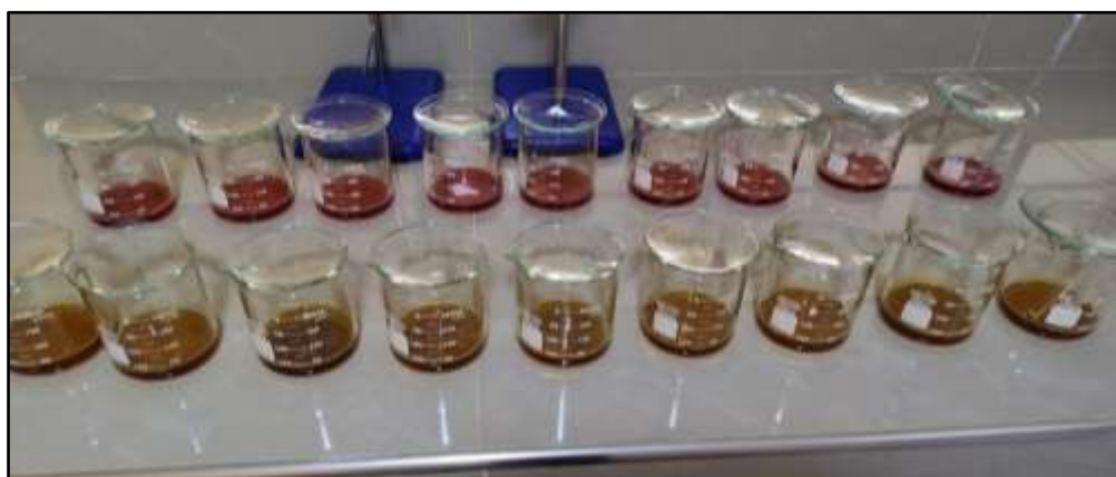
Figura 3. 4 Adición de agua destilada a los cloruros de cobalto y hierro.
