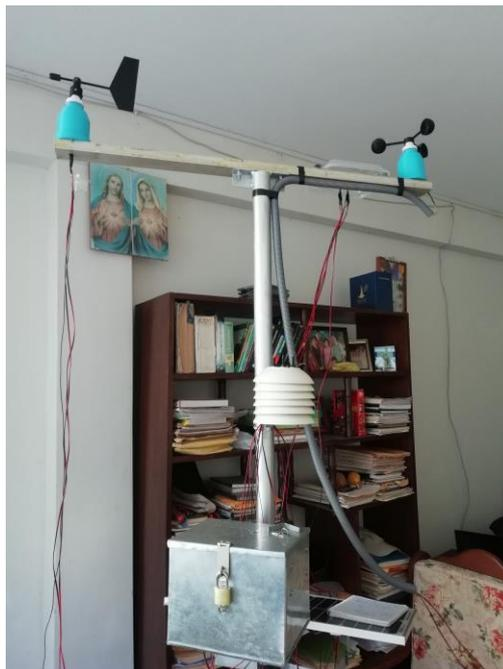
Finalmente, en una estructura independiente al cuerpo principal de la estación climática, se encuentra el pluviómetro, dispuesto a una altura de 1.3 metros según las directrices normativas aplicables. Todos los cables que se extienden hacia los sensores externos han sido recubiertos con mangueras corrugadas con el propósito de minimizar las interferencias eléctricas causadas por las variaciones climáticas.
