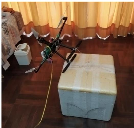
Debido a esta dificultad se decidió cambiar de imu al módulo MPU6050 porque permite proporcionar lecturas más estables de los ángulos de inclinación puesto que es menos sensible a interferencias magnéticas, además en este
