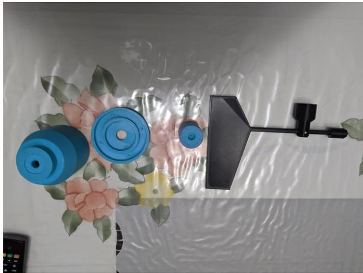
**Figura 56 : Piezas Impresas del Anemómetro**
