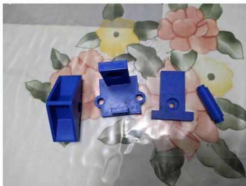
**Figura 58 : Sistema de doble Cubeta Basculante del Pluviómetro**
