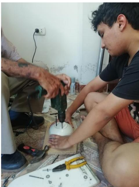
**Figura 70 : Montaje de platos invertidos en la Estructura de la Estación Climática**
