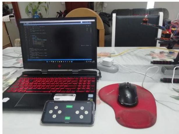
Al realizar las pruebas de esta primera versión de la aplicación se evidenció que el sistema de control por botones no es muy eficiente debido a que dentro de la aplicación es muy difícil detectar todo el tiempo que se mantiene presionado un botón y durante ese tiempo seguir enviando el carácter correspondiente, es por ello por lo que se buscó la opción de poder utilizar un joystick virtual dentro de la aplicación, simulando también los controles comunes para drones de manera física.
