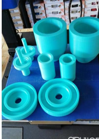
**Figura 53 : Parte Superior del Anemómetro**
