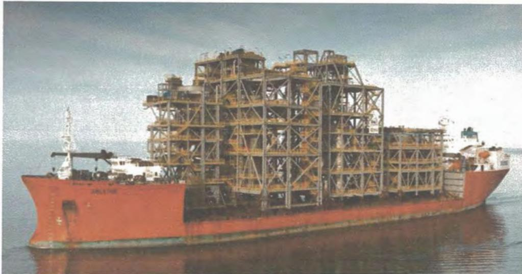
Figura 9: Transporte de modulo mediante embarcación. [19]
