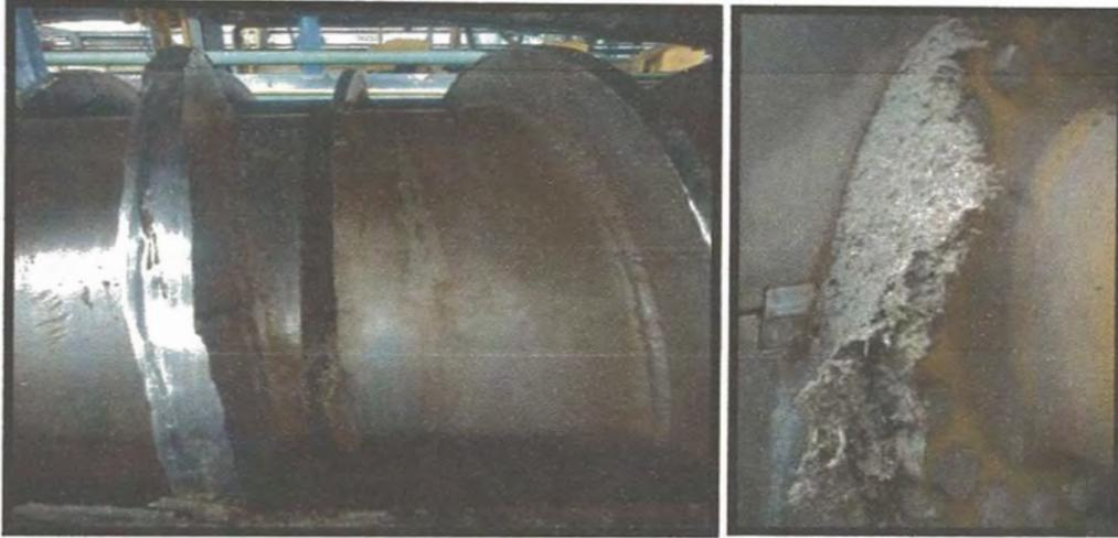
Uno de los objetivos de nuestra tesis es reducir las averías ocasionadas por las deformaciones del tornillo helicoidal, usando un nuevo diseño que disminuya estas deformaciones a través de la disminución de deflexiones sobre el tornillo helicoidal, aumentando el momento de flector del tornillo helicoidal.
