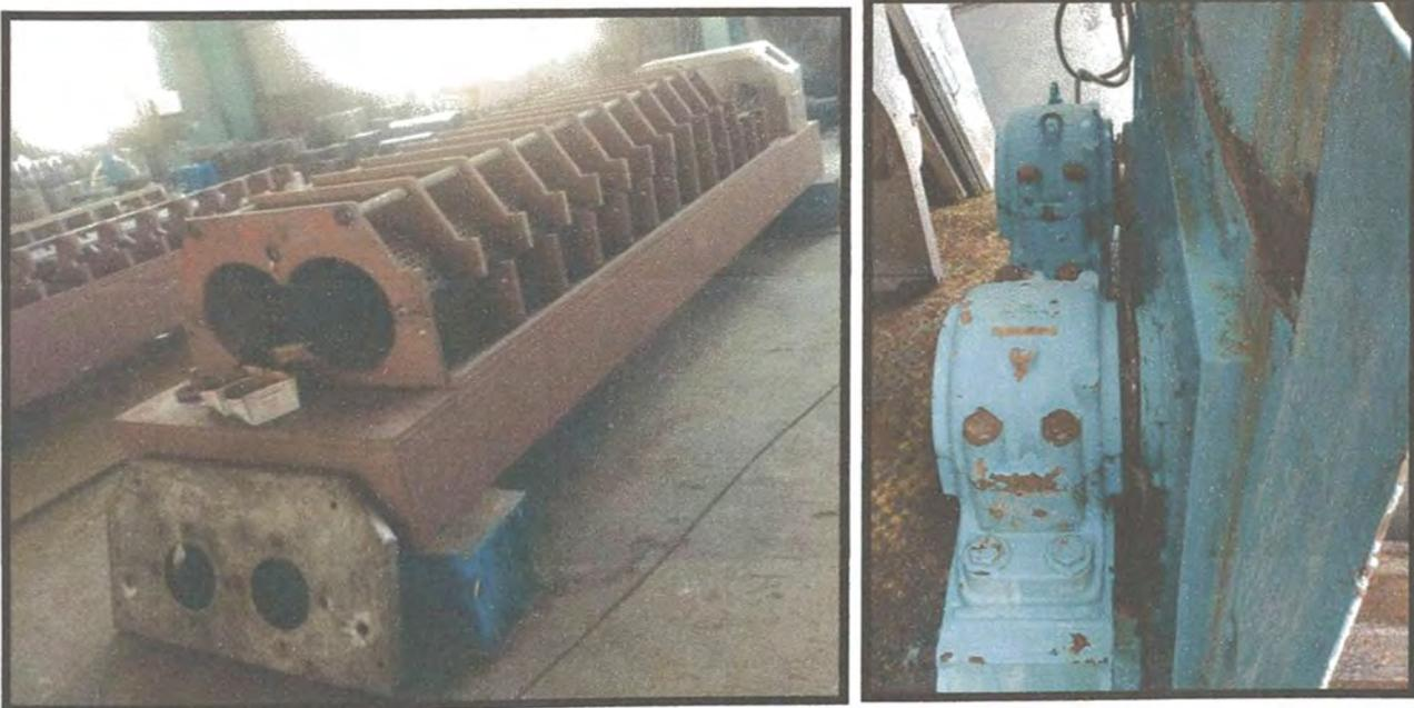
En los extremos del bastidor se colocarán chumaceras para el soporte de los tornillos helicoidales, como se ve en la Figura 41. Estas chumaceras estarán unidas a los tornillos helicoidales en paralelo por lo que su alineación será fundamental para el avance de la pasta a través de prensa.
