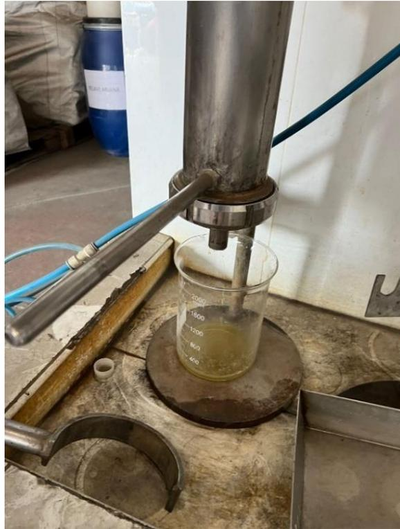
*Nota:* Pruebas realizadas en las instalaciones de METASIL, lavado de remanente de lixiviación.
