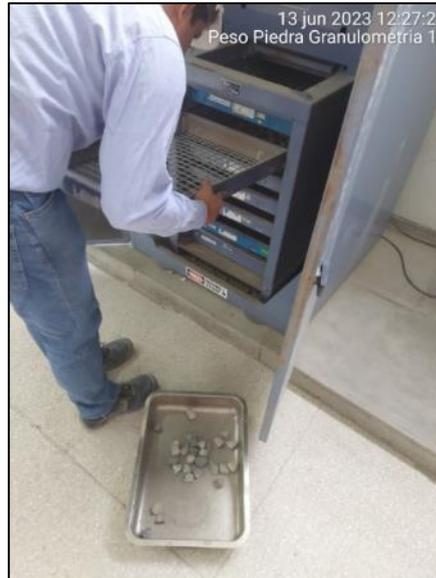
**Figura N° 10:** Retiro de la muestra del equipo tamizador.
