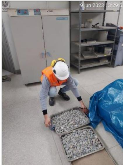
**Figura N°11:** Muestra representativa del agregado grueso
