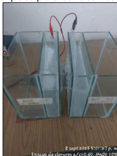
**Figura N°39:** Recipiente con las mallas y conectas a la fuente UNI-LEM
