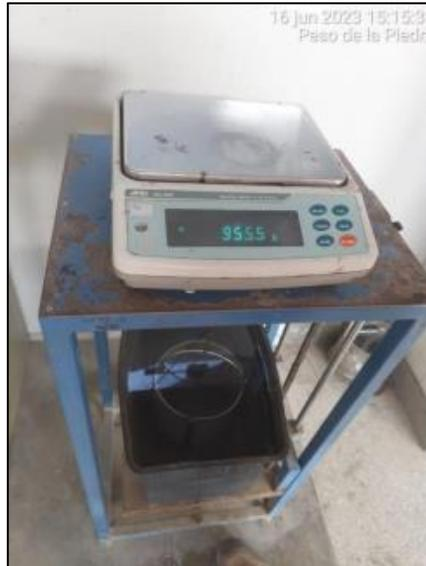
**Figura N°13:** Pesado de la muestra superficialmente seca en canastilla.
