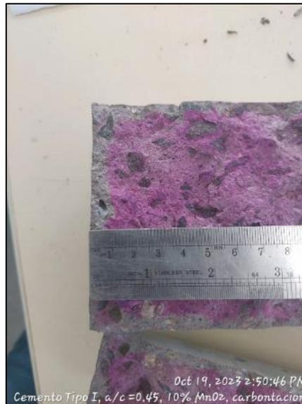
**Figura N° 48:** Medición de profundidad de carbonatación UNI-LEM
