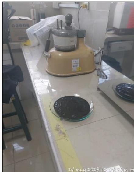
**Figura N°17:** Extracción de muestra representativa de NDMA. Fuente: Propia
