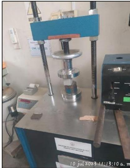
**Figura N°29:** Cubos de mortero ensayo de compresión UNI-LEM
