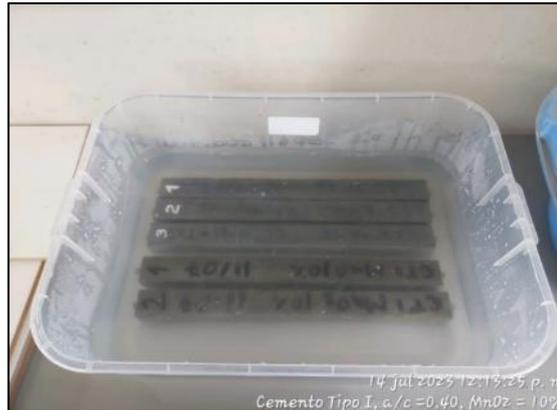
**Figura N°31:** Muestras sumergidas en solución de sulfato de magnesio
