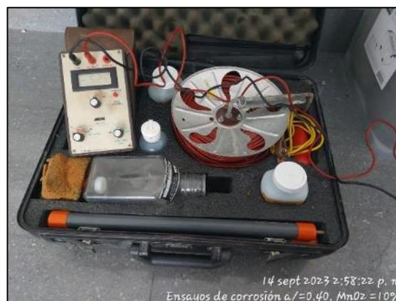
**Figura N°42:** Equipo de medición de potencial eléctrico MC MILLER Co UNI-LEM
