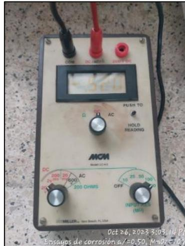
**Figura N°43:** Voltímetro configurado UNI-LEM
