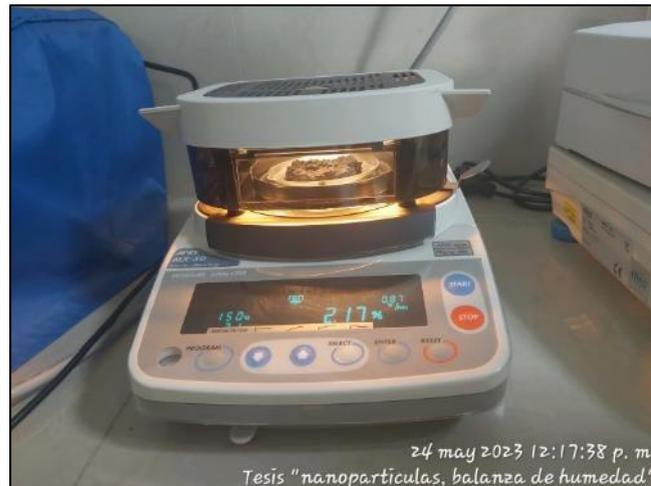
**Figura N°18:** Balanza de humedad con muestra de NDMA. Fuente: Propia
