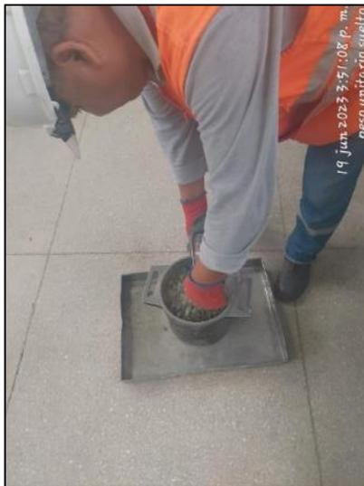
**Figura N°16:** Llenado por capas en molde UNI-LEM
