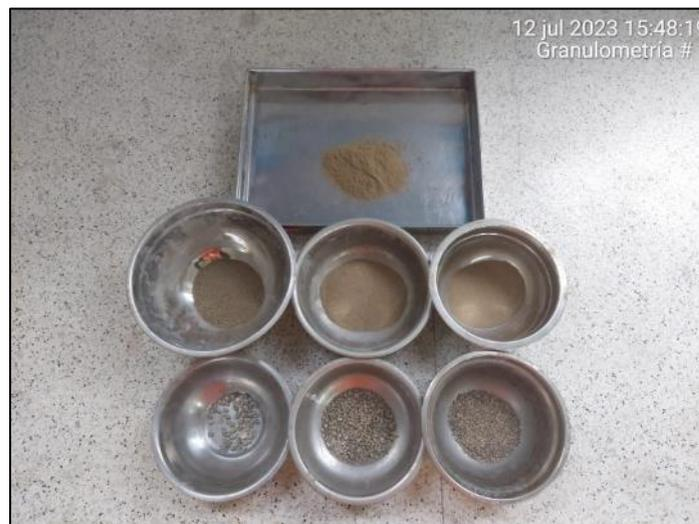
**Figura N°8:** Partículas de AF retenidas en los tamices UNI-LEM Fuente: Propia
