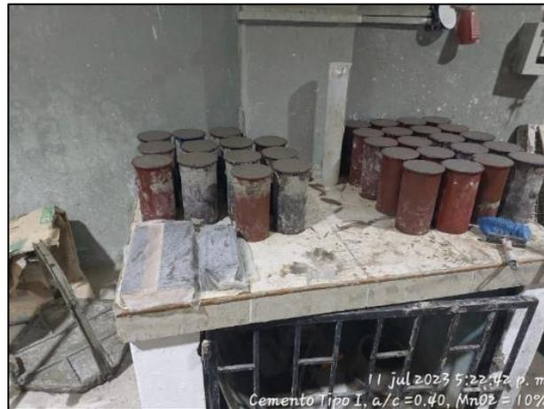
**Figura N°34:** Probetas de 100mm x 200 mm UNI-LEM
