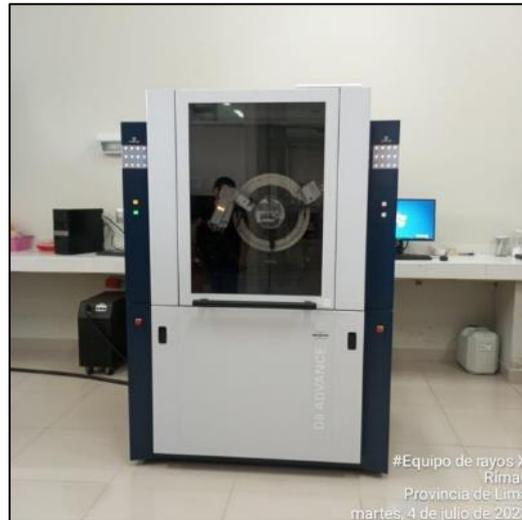
**Figura N°23:** Difractómetro de rayos X Bruker D8 Advance
