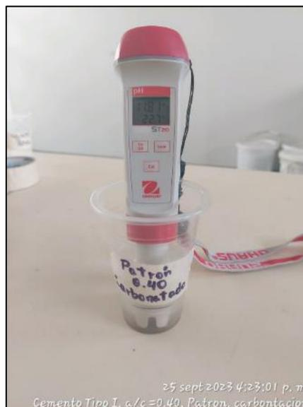
**Figura N° 49:** Medición de pH de muestra carbonatada UNI-LEM
