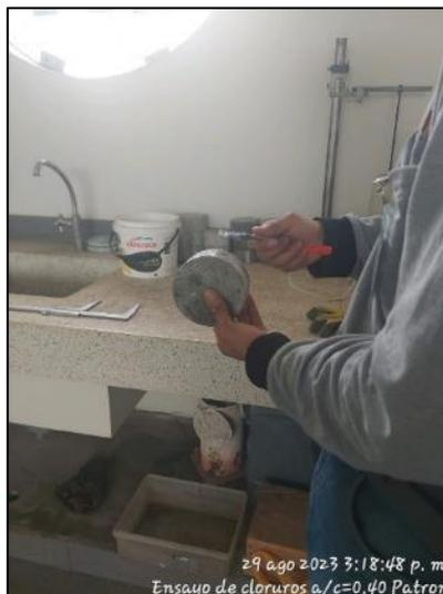
**Figura N°37:** Impermeabilización de la muestra con silicona líquida UNI-LEM
