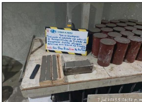
Figura N°28: Llenado de moldes con mortero UNI-LEM
