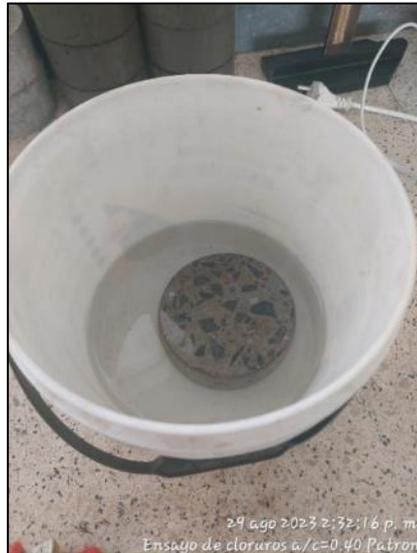
**Figura N°36:** Muestra sumergida en agua destilada UNI-LEM
