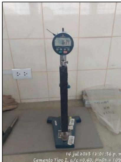
**Figura N°32:** Medición en comparador de longitud UNI-LEM
