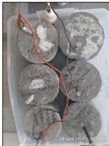
**Figura N°44:** Electrodo de referencia en medición UNI-LEM
