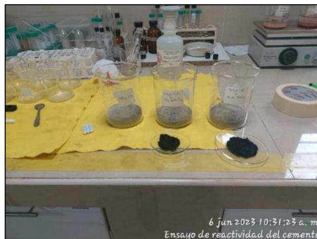
Figura N°21: Muestras de cemento con NDMA. Fuente: Propia
