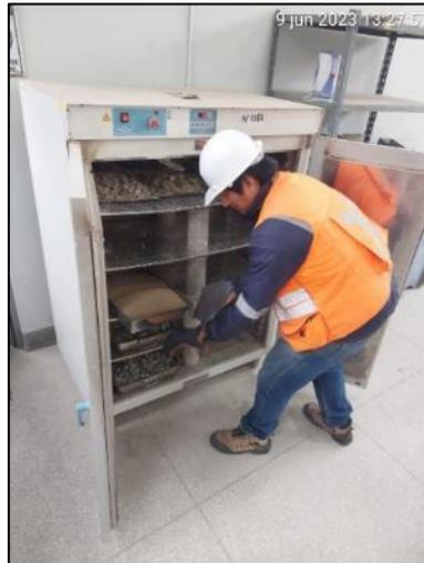
**Figura N°14:** Colocación de muestras en horno UNI-LEM
