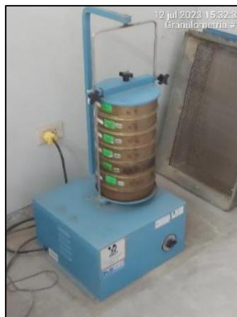
**Figura N°7:** Tamices colocados en tamizador eléctrico
