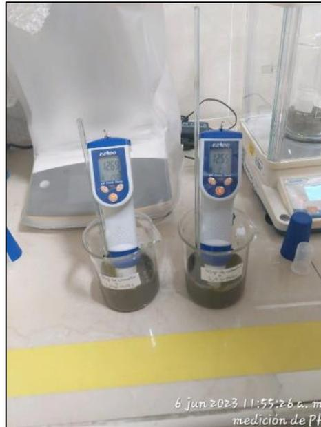
Figura N°20: Medición de pH. Fuente: Propia
