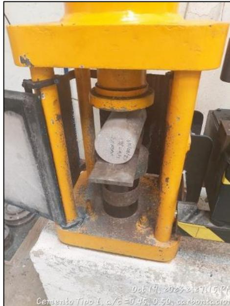
**Figura N°47:** Corte axial de probeta UNI-LEM
