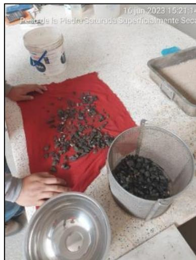
**Figura N°12:** Muestra saturada superficialmente seca
