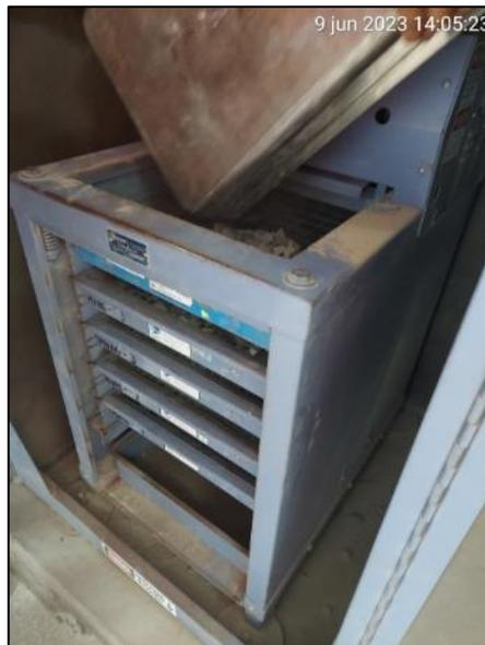
**Figura N°9:** Muestra colocada en el equipo tamizador UNI-LEM Fuente: Propia
