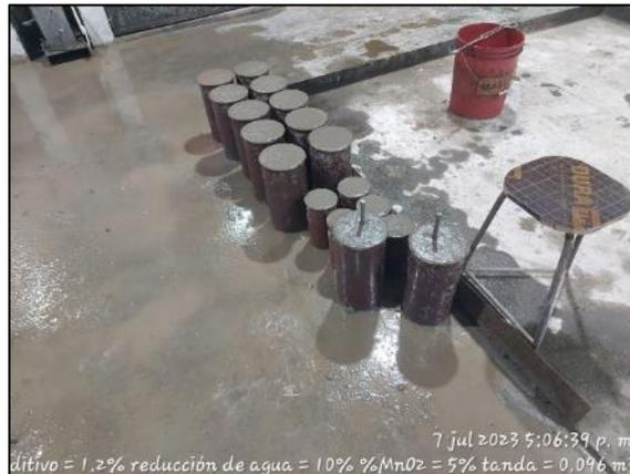
**Figura N°41:** Preparación de probetas de 150x300 mm UNI-LEM
