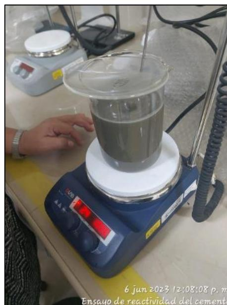
Figura N°22: Agitador magnético con medidor de temperatura. Fuente: Propia
