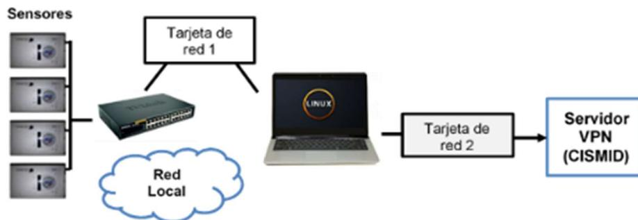
Figura 3.13 Diagrama de sistema de comunicación centro de monitoreo local – CISMID.
