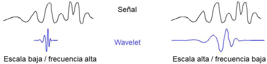
Figura 2.9 Esquematización del factor de escalamiento "a".
