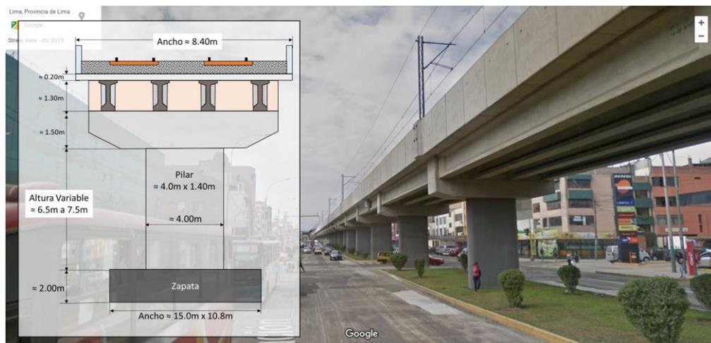
Figura N°29: Esquema del viaducto T4 del tramo I.
