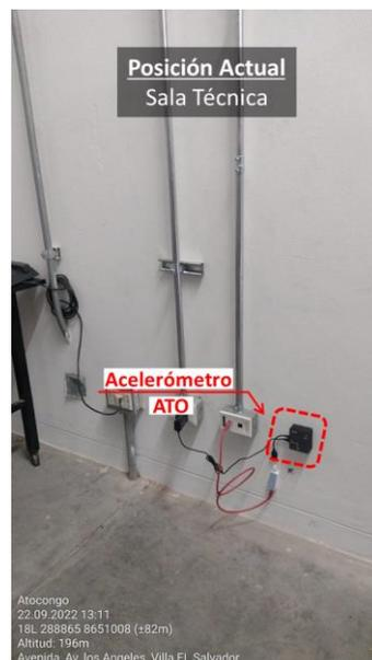
Figura N°87: Fotografía de acelerómetro ATO.
