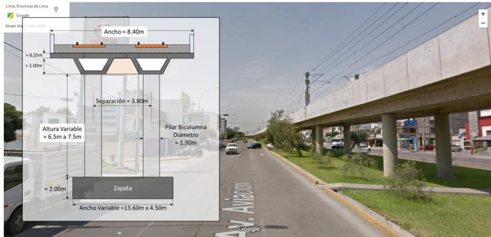
Figura N°28: Esquema del viaducto T3 del tramo I.
