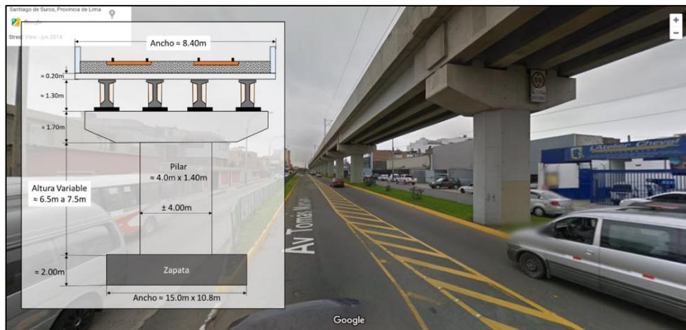
Figura N°27: Esquema del viaducto T2 del tramo I.
