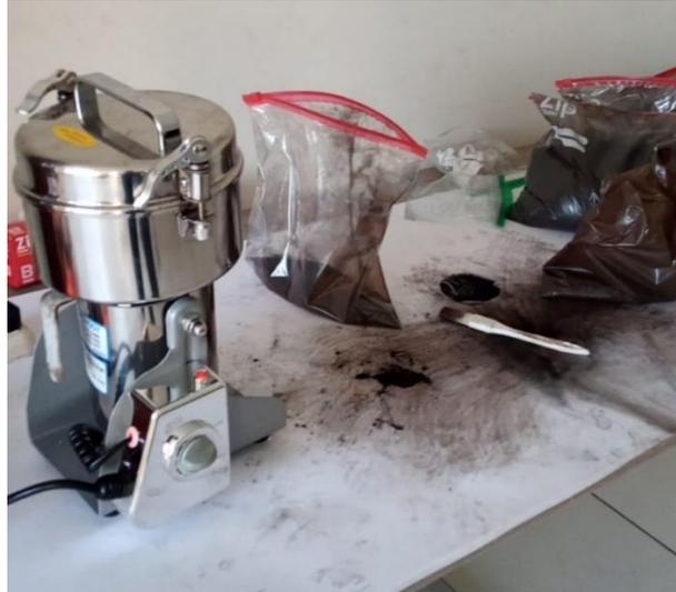
Figura N° 3 Pulverización de muestra seca de NDMA.
