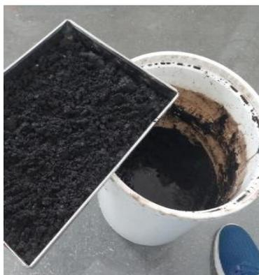
Figura N° 2 Muestra de lodo de NDMA.
