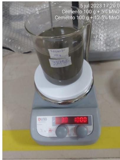
Figura N° 8 Medición de la temperatura de la pasta de cemento con NDMA en agitador magnético.
