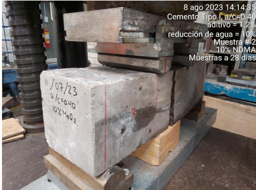
Figura N° 32 Ensayo de flexión del concreto con 10% de NDMA, a/c=0.40.
