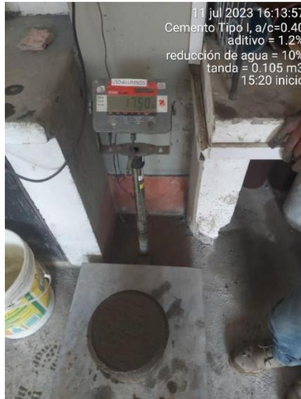
Figura N° 15 Ensayo de peso unitario del concreto de a/c=0.40 con 10% de NDMA.
