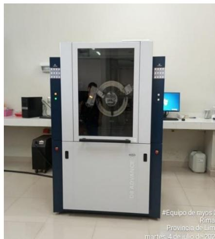
Figura N° 4 Equipo Difractómetro de Rayos X: Bruker D8 Advance.
