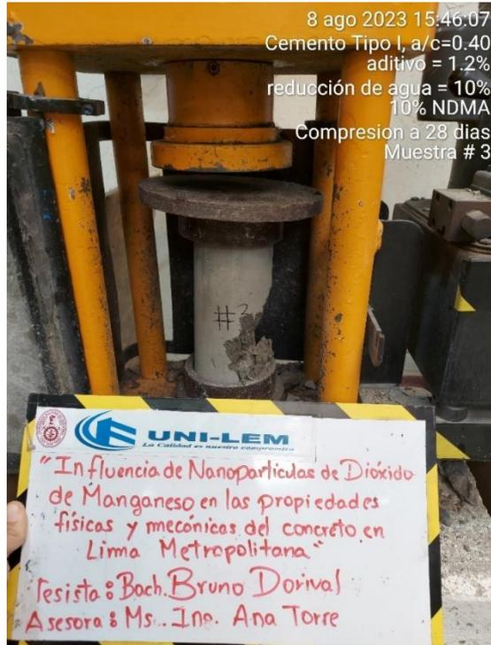
Figura N° 23 Ensayo de compresión del concreto con 10% de NDMA, a/c=0.40.
