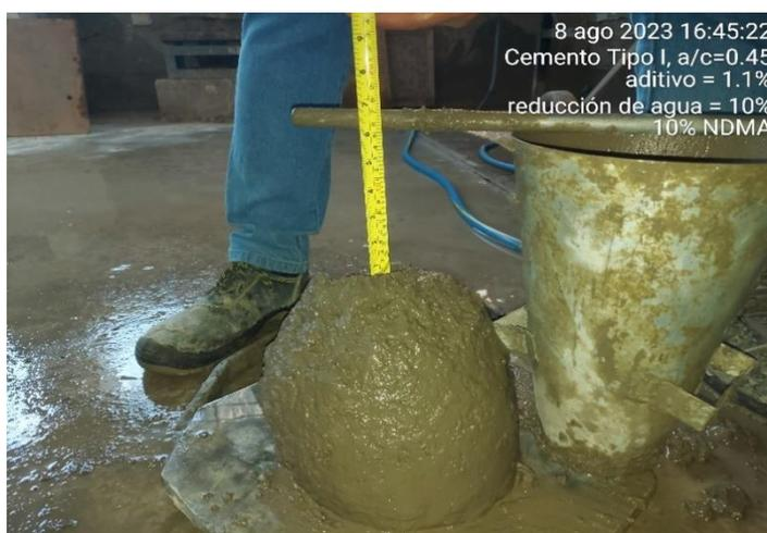
Figura N° 13 Ensayo de asentamiento del concreto con 10% de NDMA,  $a/c=0.45$ .
