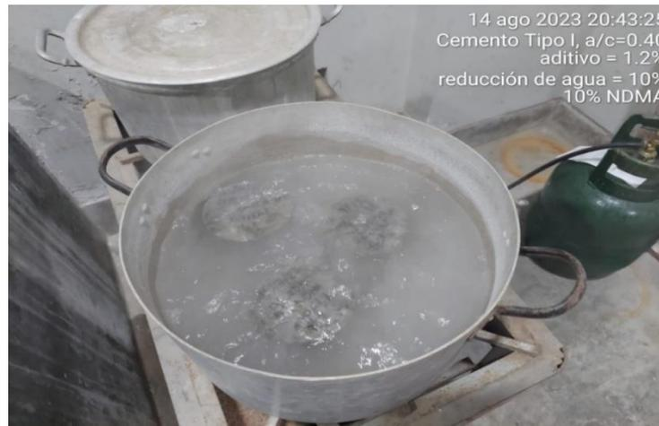
Figura N° 19 Ebullición en agua de discos de concreto con 10% de NDMA, a/c=0.40.
