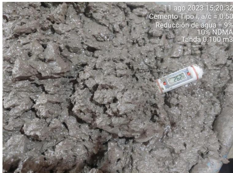
Figura N° 17 Ensayo de medición de temperatura del concreto con 10% de NDMA, a/c=0.50.
