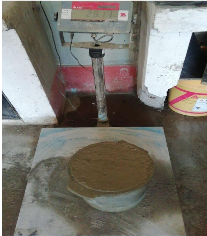
Fotografía 9.-Muestra de concreto fresco a ser ensaya en peso unitario compactado.
