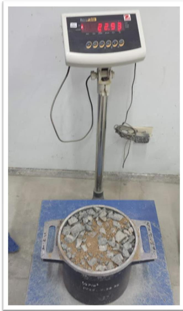
Fotografía 7.-Muestra de agregado a ser ensayada en peso unitario compactado.
