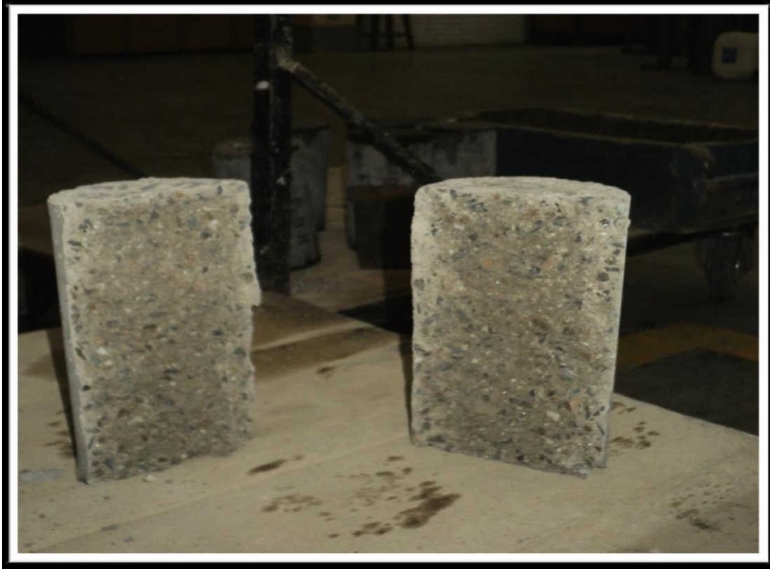
Fotografía 15.-Probeta de concreto ensayada por ensayo de tracción por compresión diametral
