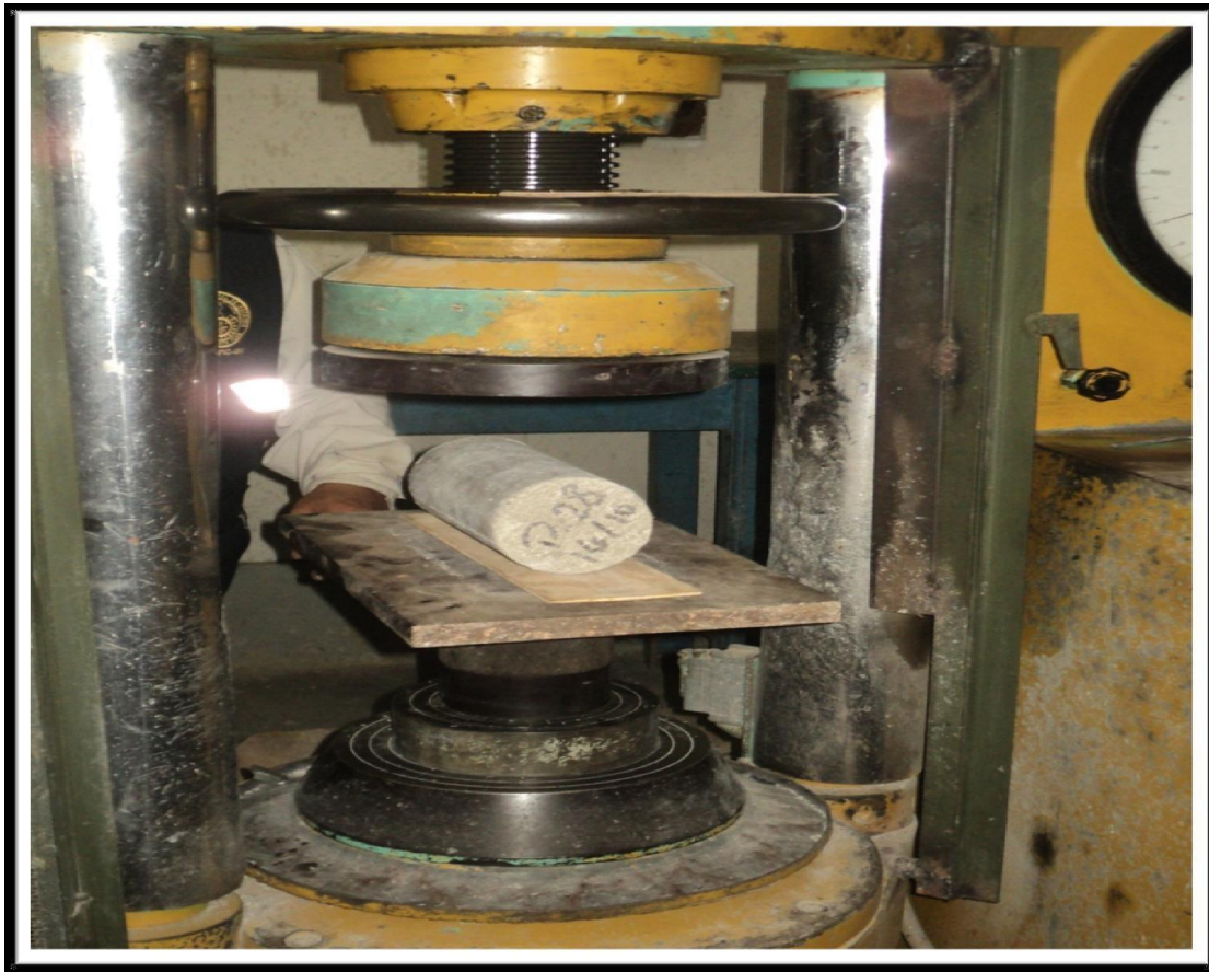
Fotografía 13.-Ensayo de resistencia a la compresión
