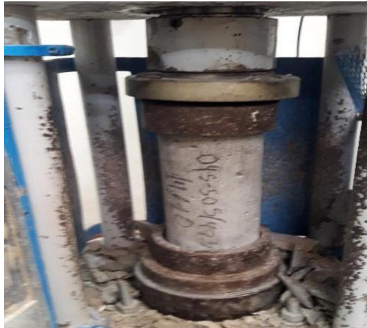
Fotografía 13.-Ensayo de resistencia a la compresión
