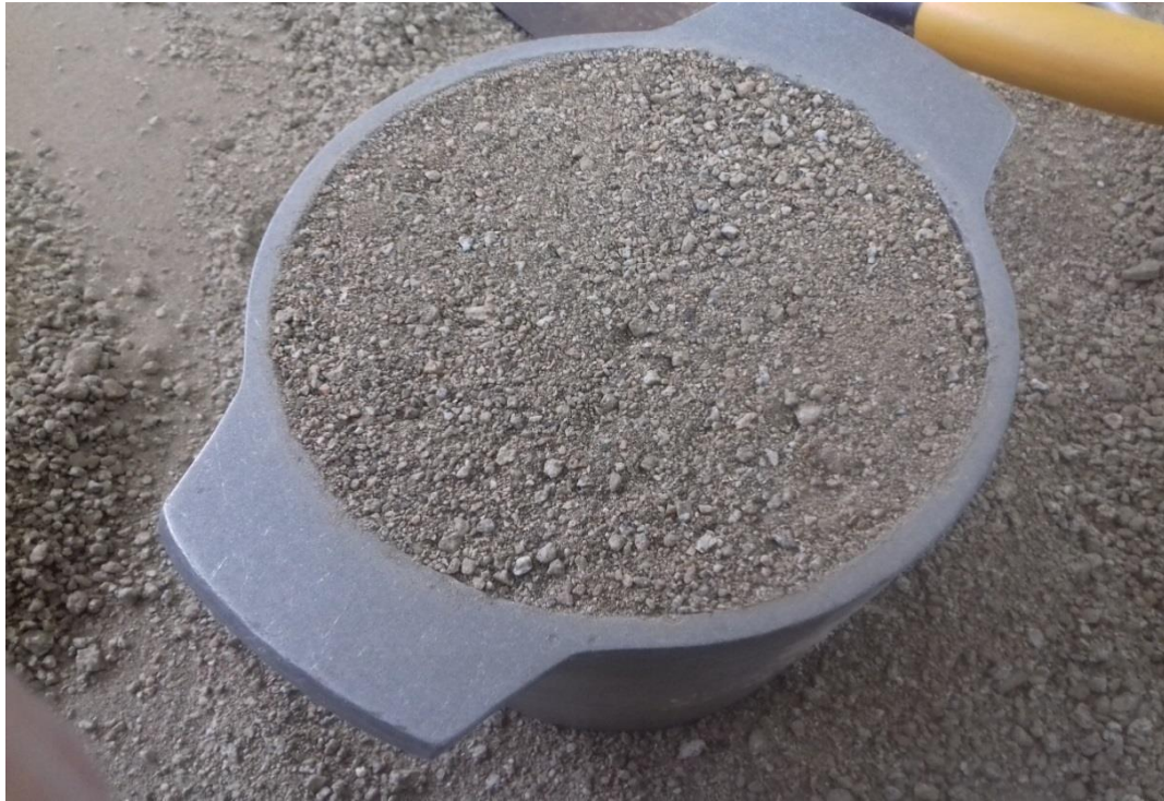
Fotografía 3.-Muestra de agregado fino a ser ensayada en peso compactado
