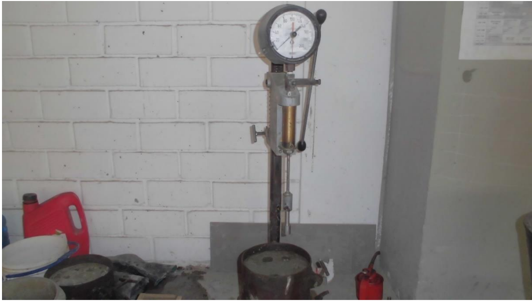
Fotografía 12.-Muestra de concreto fresco a ser ensayada (tiempo de fragua).
