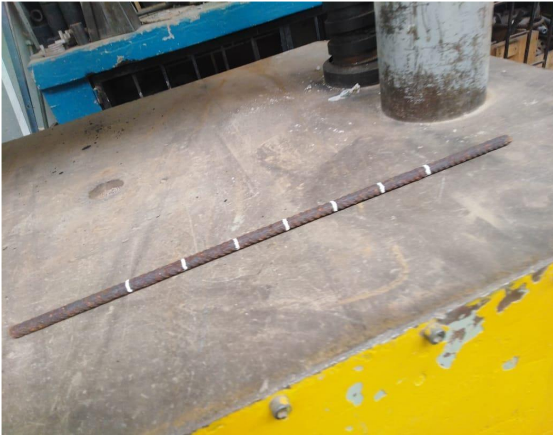
Imagen 9. Acero Oxidado por sales (demarcado para ser sometido al ensayo)
