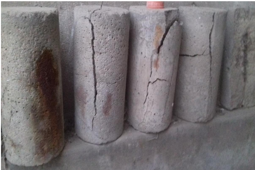
Fotografía 16.-Efectos de cloruro de sodio en el mortero armado (Rimarachin, 2014). ANEXO
