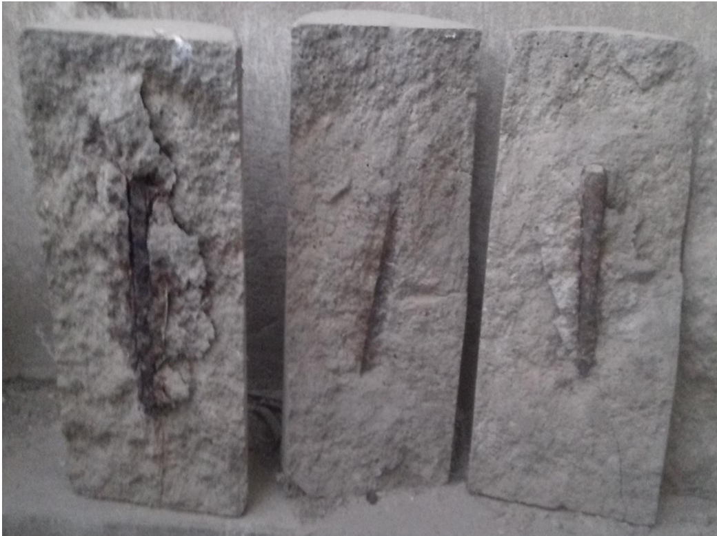
Fotografía 16.-Efectos de cloruro de sodio en el mortero armado (Rimarachin, 2014). ANEXO
