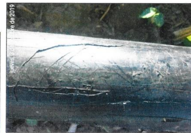
Figuras 3 y 4: Daños superficiales (ralladuras) de la tubería HDPE Ø2"
