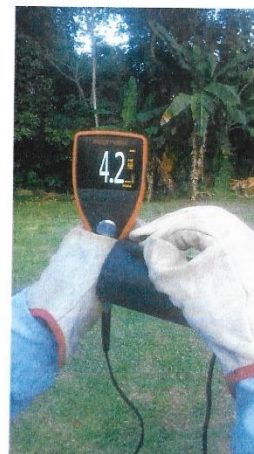
Foto 3: Medición de Espesor de tubería HDPE 2" con Equipo UT, resultado: 4.2mm.
