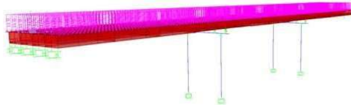
Figura 5.14. Carga de Asfalto distribuida a lo largo de todo el Puente.
