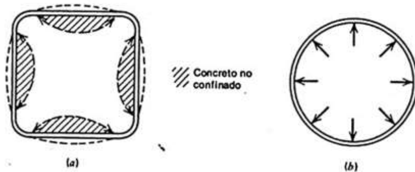
Figura 2.21. Confinamiento por aros cuadrados y hélices (a) aro cuadrado, (b) hélice (Park y Paulay, 1983)
