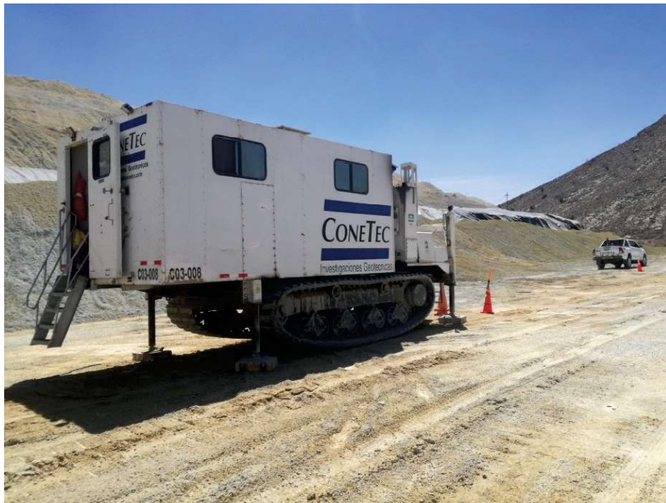
Figura°2.14 Equipo de 20 toneladas sobre orugas (Fuente propia)
