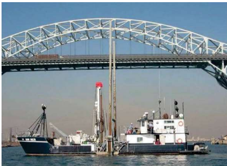
Figura 2.18 Equipo tipo barcaza perforación de 25 toneladas (Robertson and Cabal, 2015)
