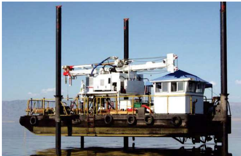
Figura 2.17 Equipo tipo anfíbio perforación de 25 toneladas (Robertson and Cabal, 2015)
