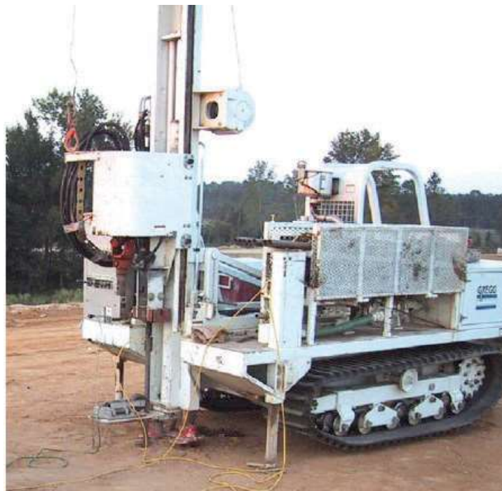
Figura°2.16 Equipo multipropósito perforación de 7 toneladas (Robertson and Cabal, 2015)
