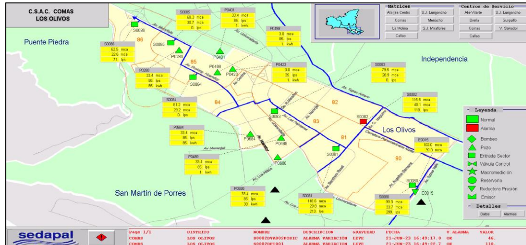
Figura 3.5 Sectores abastecidos con fuente de agua superficial y sectores abastecidos con fuente de agua superficial y agua subterránea del distrito de Los Olivos. Fuente: (Sistema SCADA Metropolitano de SEDAPAL, 2024).
