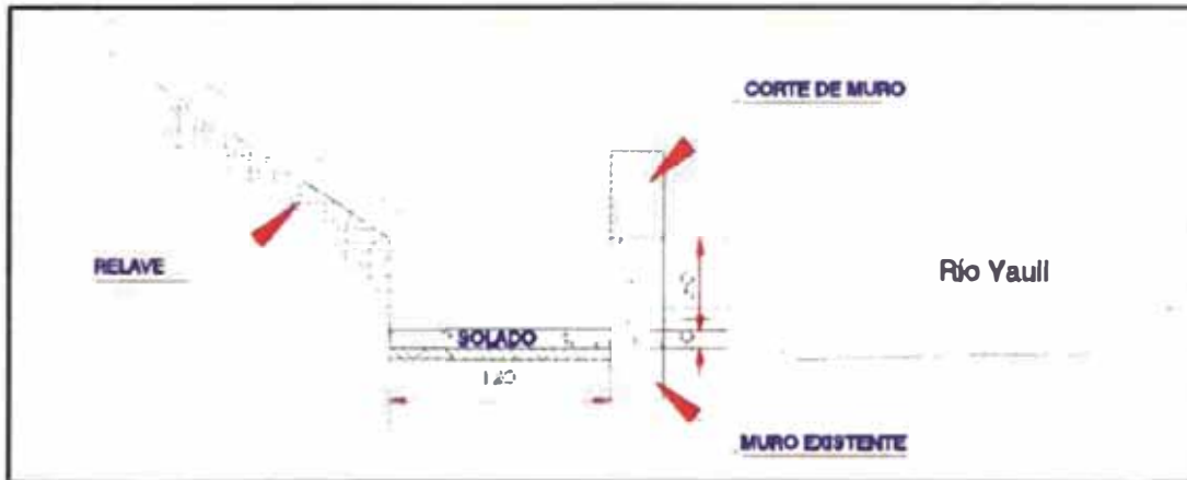
Figura 2.5 Demolición de Muro existente con referencia a la zapata de la zapata nueva.
