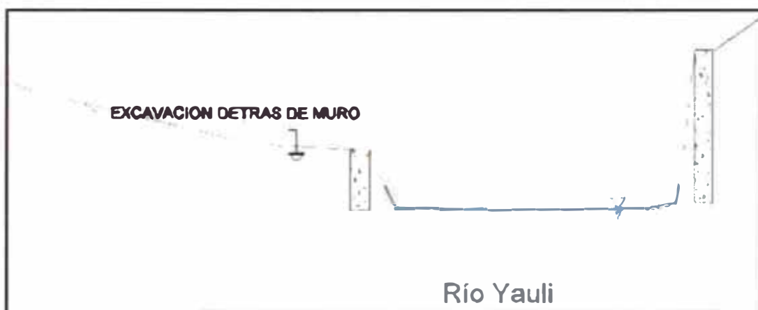
Figura 2.4 Sección Transversal típica de Excavación.
