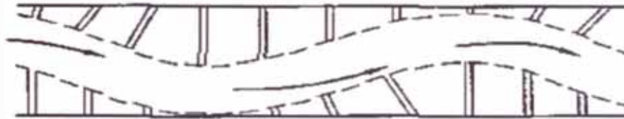
Figura N° 2.8 Fijación de un cauce por medio de espigones
