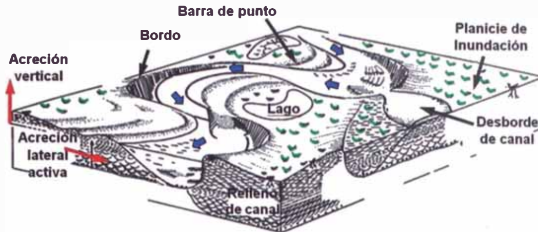
Figura N° 1.9 Características morfológicas de un sistema fluvial meándrico.
