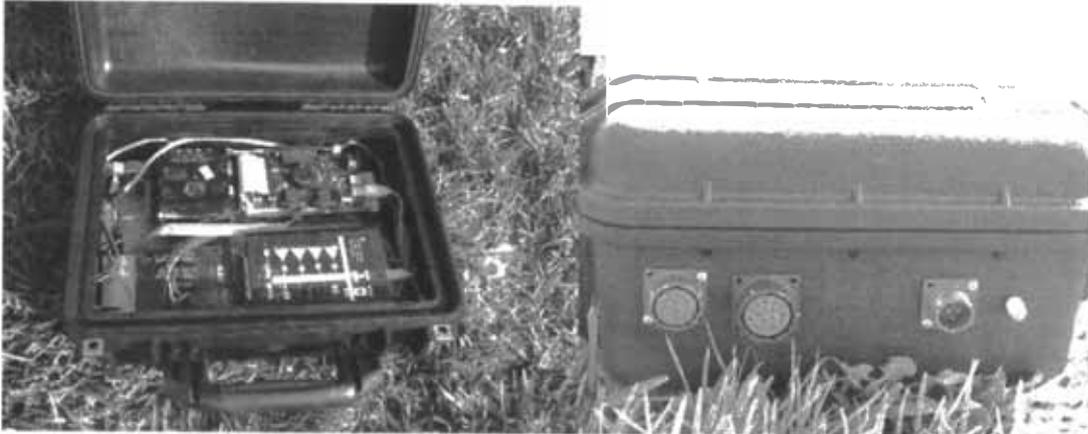
Figura 3.12 Distribución del hardware y vista lateral del ADQREDES
