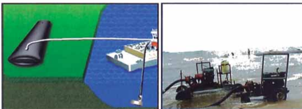
Figura N° 2.1.- Izquierda: En esta imagen se muestra el sistema de dragado desde el fondo del río o del mar. Derecha: Se muestra el sistema de dragado desde la playa, orilla.
