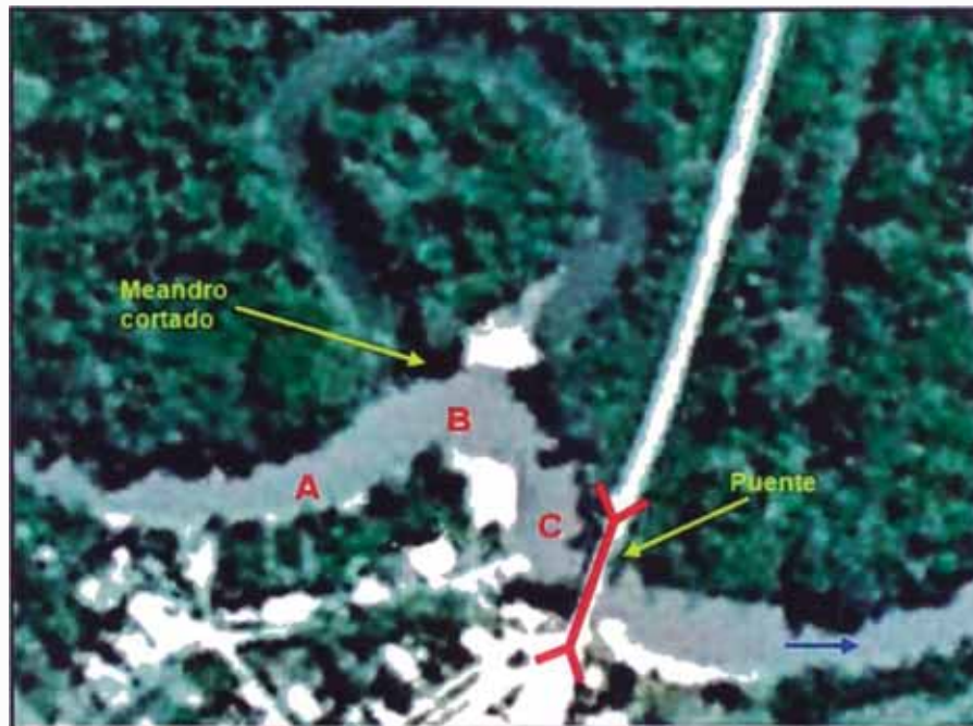
Figura N° 1.11.- Río Manuripe en el año 2005, se observa el corte del meandro.
