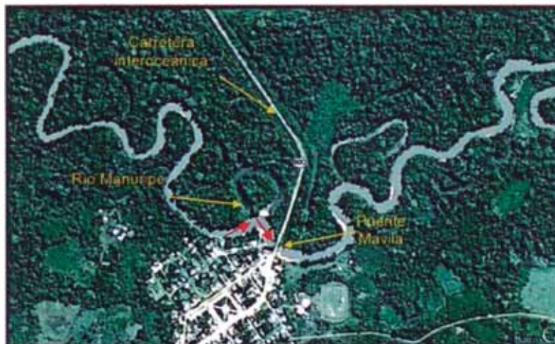
Figura N° 1.1.- Geometría curva en forma de S aguas arriba del puente Mavila I.
