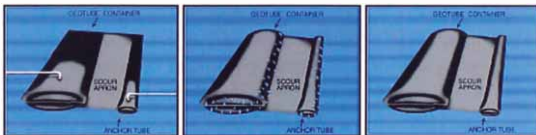
Figura N° 1.6.- Izquierda: Llenado, Centro: Contención, Derecha: Estructural
