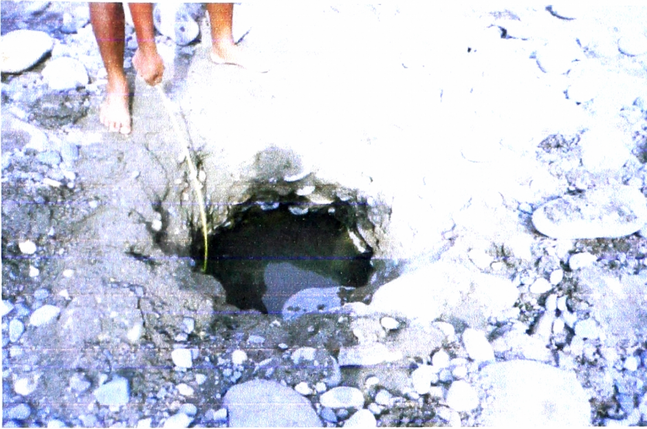
FOTO 19 Se observa en la Calicata el tipo de material que arrastra el río.
